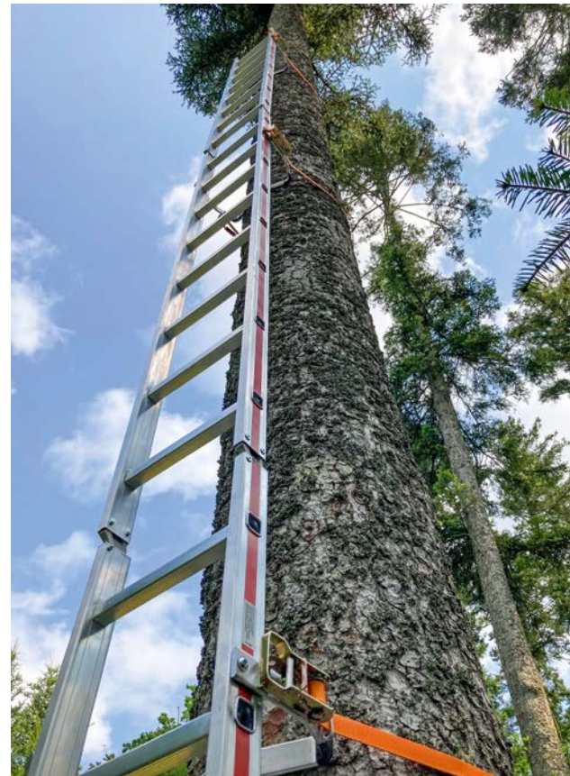
Abb. 2: Distelleiter in gesicherter Arbeitsposition am Baum (Foto: Burkhard Baumsteigtechnik GmbH)
