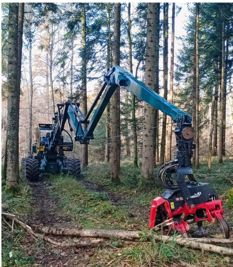
Das Outreach Fäller-Vorrücke-Fahrzeug wurde erfolgreich unter Praxisbedingungen erprobt (Foto: KWF)
