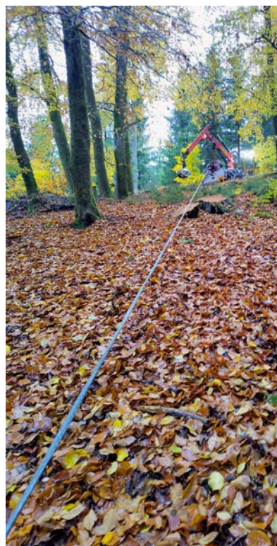
Abbildung 10: Lippmann Forstwindenseil UHMWPE (Foto: MSP Gehren)
