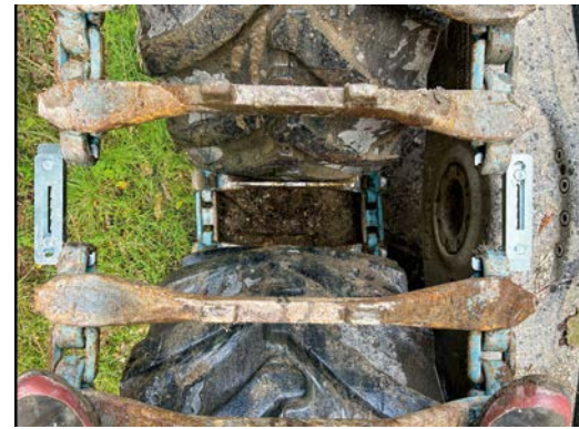
Abbildung 11: Einstellbare Montageklammer für Bogiebänder (Foto: KWL Rheinland-Pfalz)
