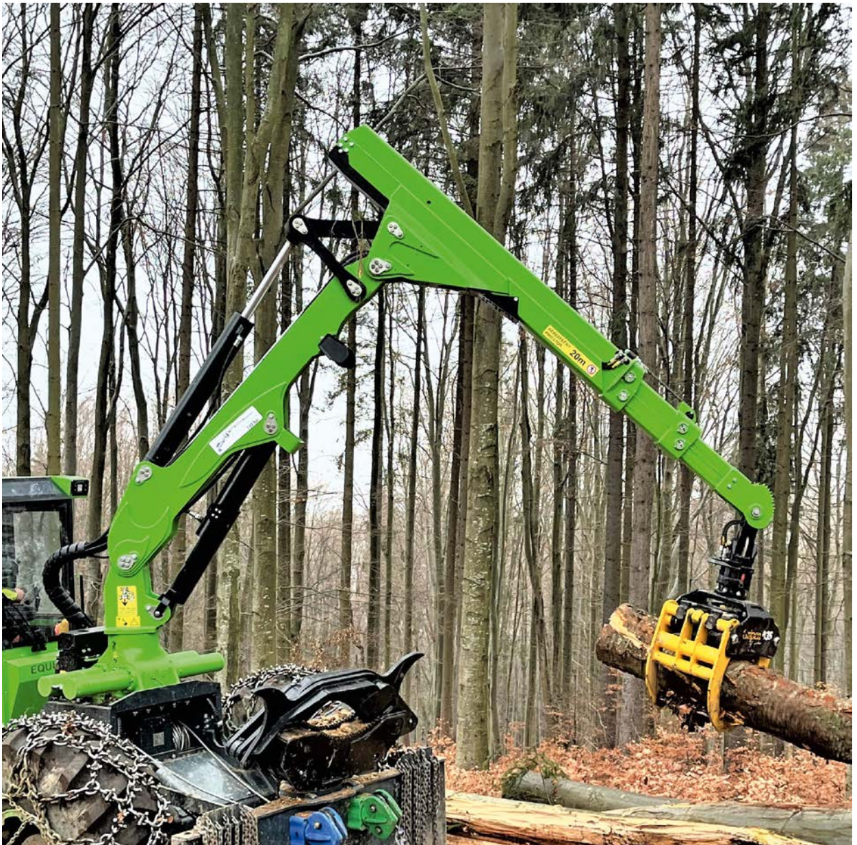
Bild 4: Ausleger mit innenliegenden Hydraulikleitungen (Quelle: KWF e.V.)
