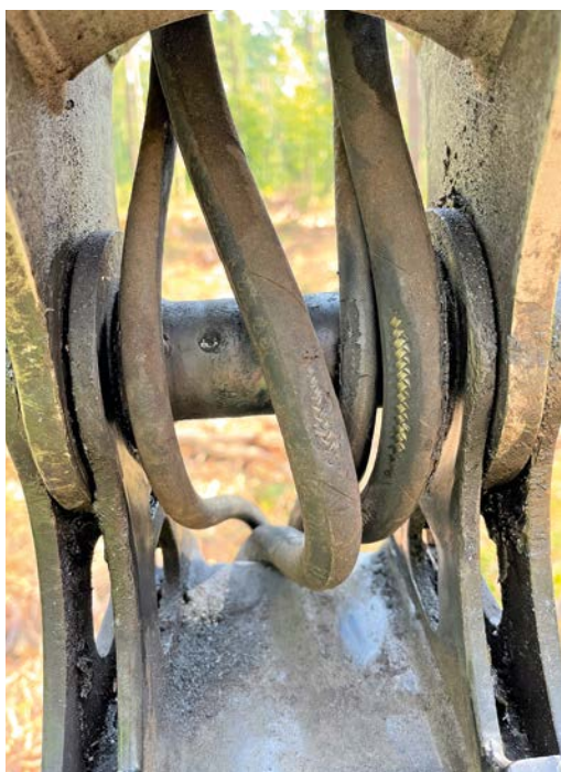
Bild 3a: Hydraulikleitungen mit Scheuerstellen (Quelle: KWF e.V.)
