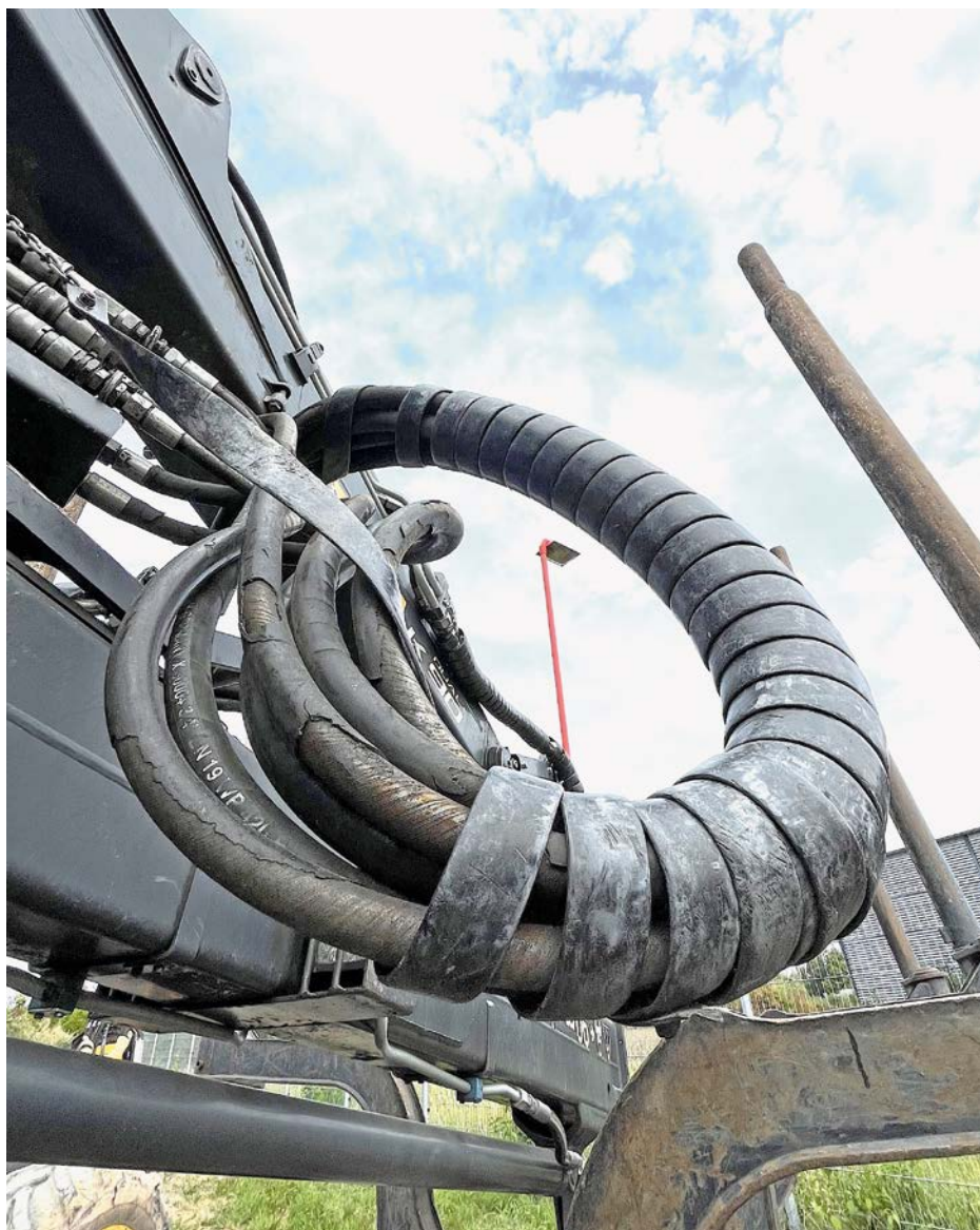
Bild 7: Beschädigte Hydraulikschläuche (Quelle: KWF e.V.)
