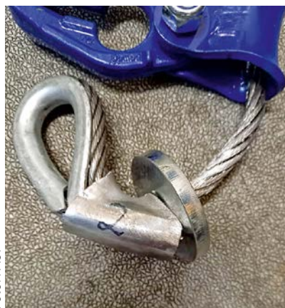
Bild 3: Zerstörte Alupressklemme nach rückwärtiger Belastung durch einen Seilgleiter
