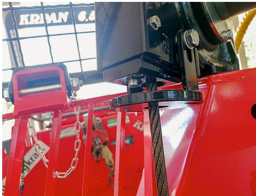
Bild 5: Endabschalter im Bereich der Seileinlaufrolle führen zu einer Reduktion der Belastungen an der Seilendverbindung und erhöhen deren Lebensdauer.
