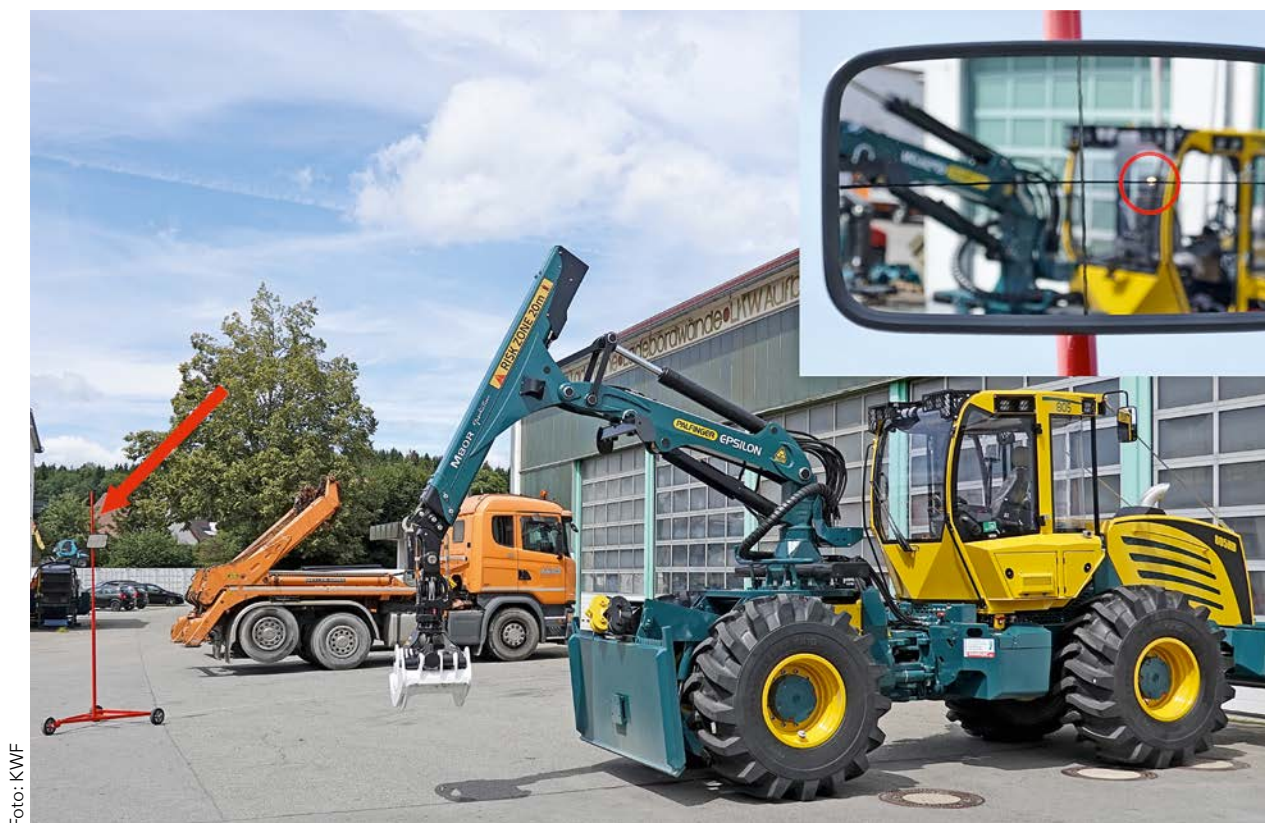
Bild 7: Sichtfeldprüfung nach DIN 30760 – Sichtfeldprüfgerät gekennzeichnet; kleines Bild – Leuchtpunkt des Sehstrahls im Prüfspiegel
