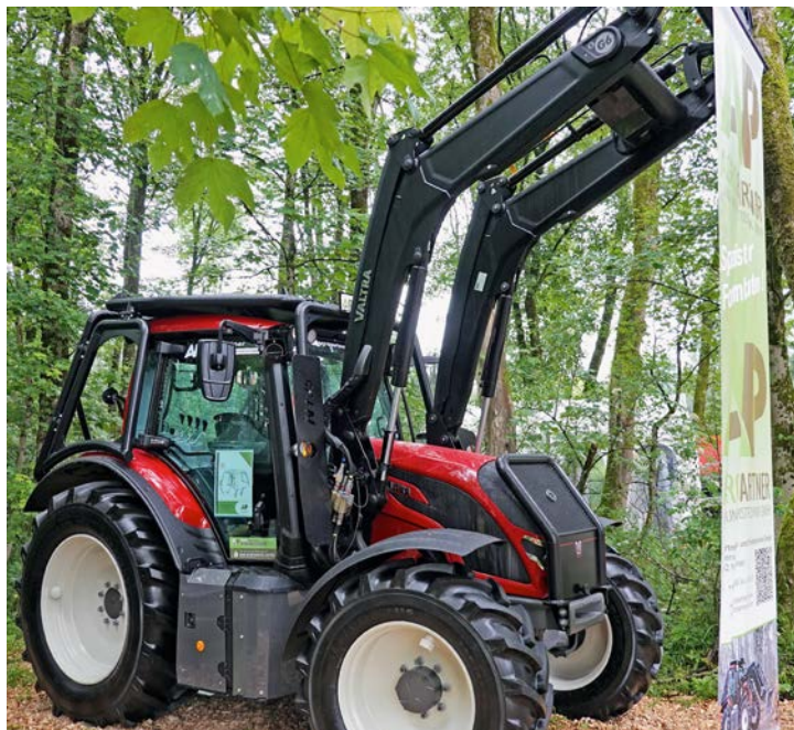
Bild 11: Nachgerüsteter FOPS-Käfig geprüft mit einer Einschlagenergie von 11600 J
