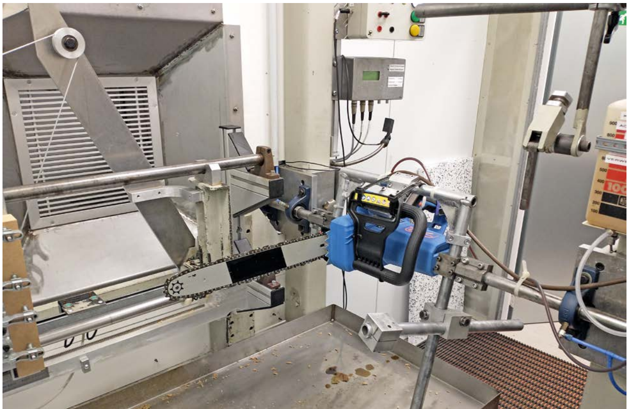
Bild 1: Prüfstand für die Bewertung der Kickbackneigung einer Kettensäge
