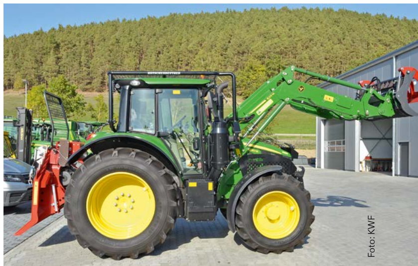
Bild 10: Typischer landwirtschaftlicher Traktor mit typischer Forstschutz-ausrstung
