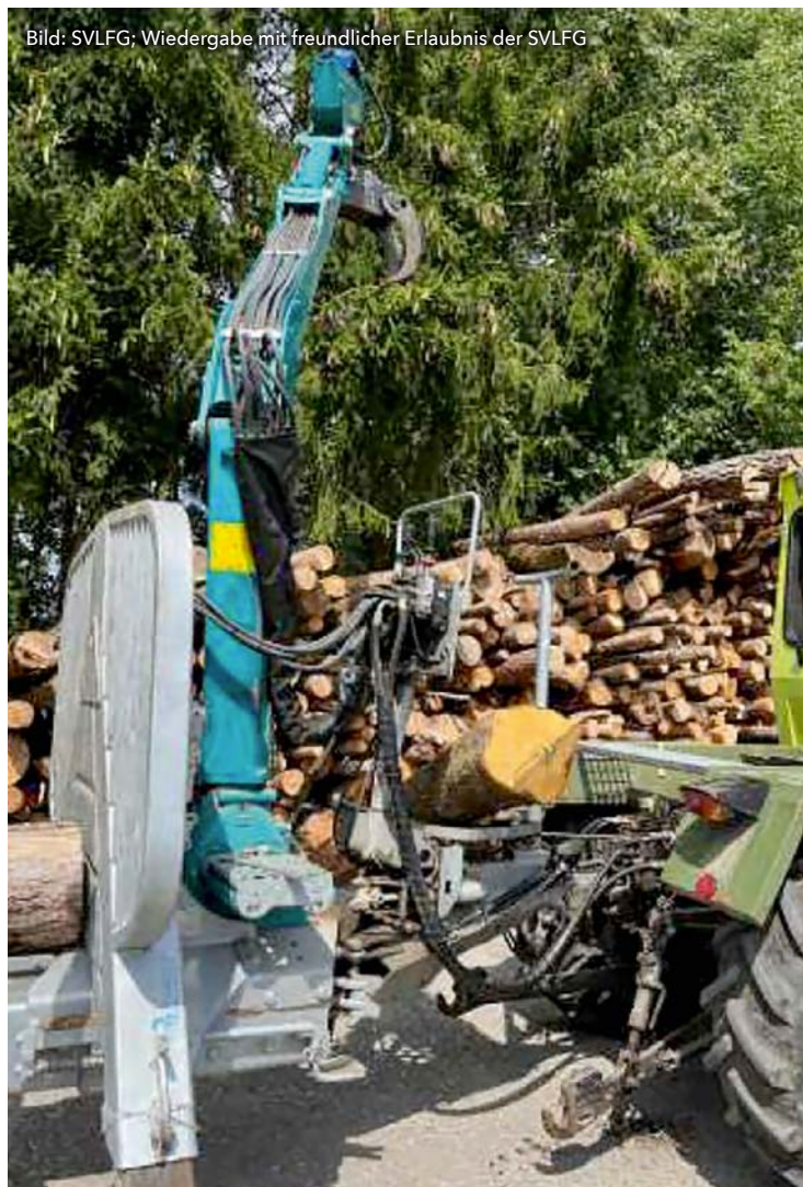
Bild 13: Unfall mit einem Rückanhänger; Bediener auf dem Deichselbedienstand von einem Abschnitt getroffen; der Abschnitt liegt noch auf dem Bedienstand
