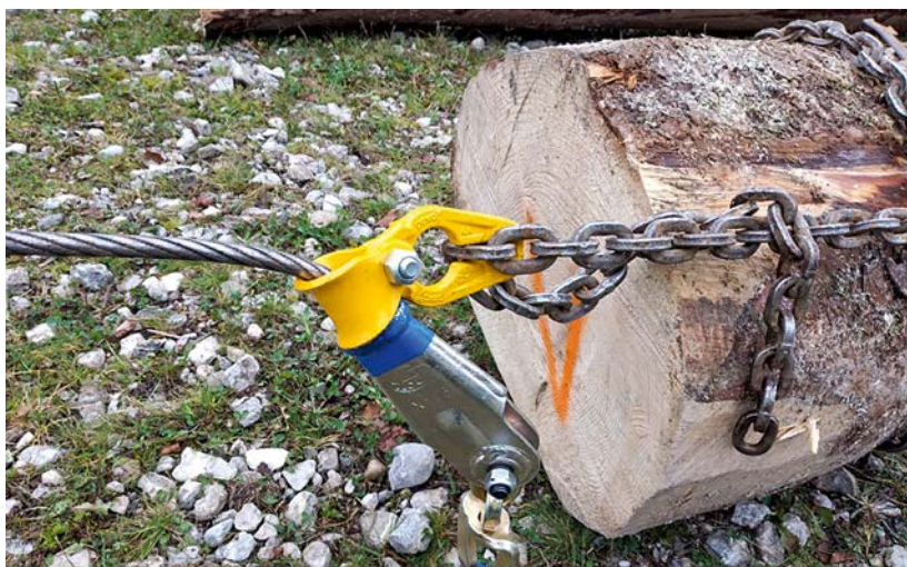
Bild 4: Die Verwendung von Seilgleitern führt zu keiner nennenswerten Schwächung von Seilschlössern. Um ein unbeabsichtigtes Lösen des Seiles im Seilschloss zu verhindern, sollte – anders als im Bild dargestellt – zuerst die Last am Seilschloss angebracht werden.
