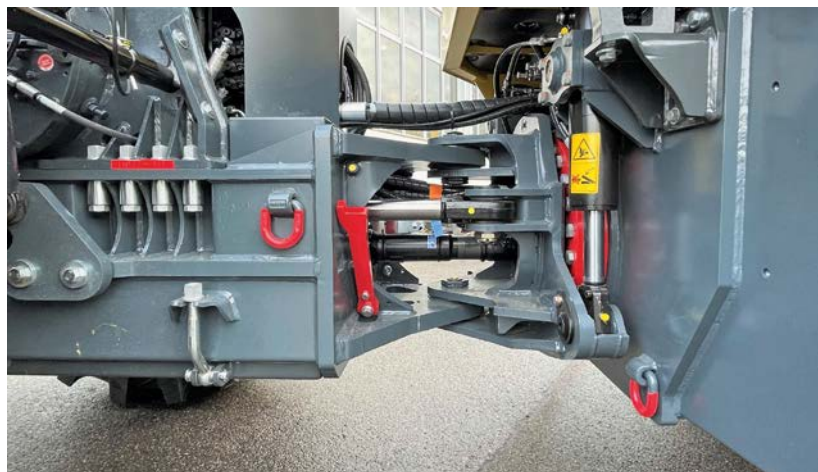
Abbildung 3: vorbildliche Anschlagpunkte am Mittelgelenk (rote Ösen) Quelle: KWF
