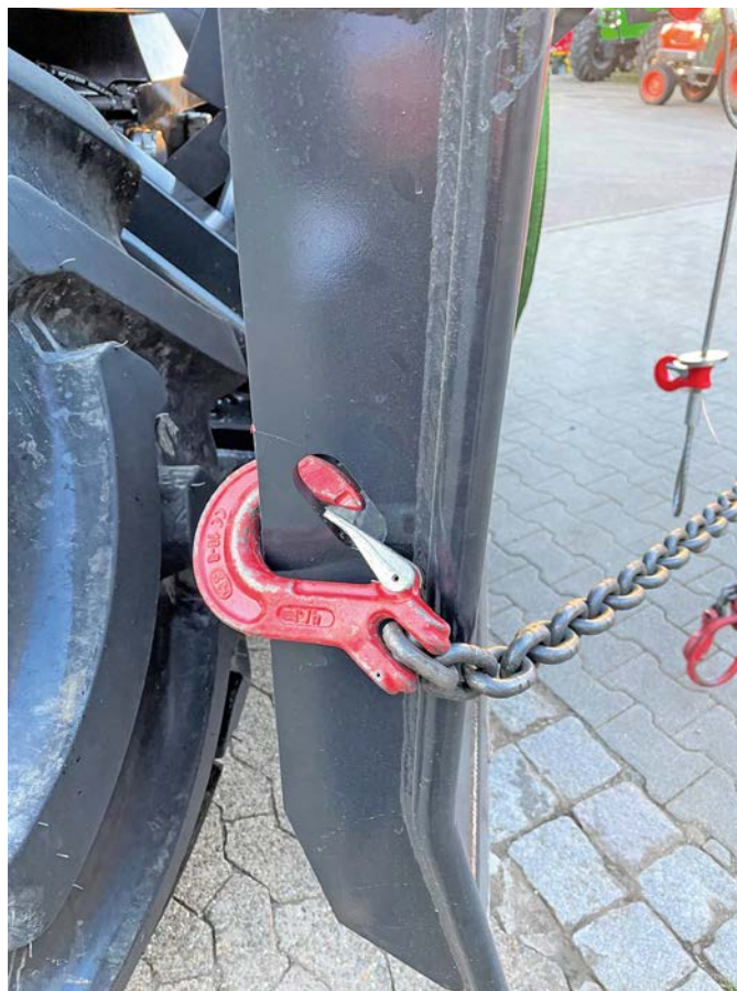
Abbildung 4: unvorteilhafter Anschlagpunkt Quelle: KWF
