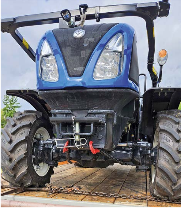
Abbildung 5: Ungesicherte Haken (rot) Quelle: KWF
