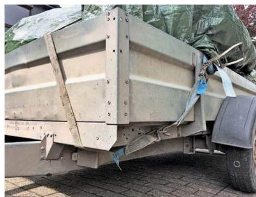
Abbildung 2: Fehlerhaftes Verwenden von Zurrmitteln führt oft zu Unfällen. Werden defekte Zurrmittel nicht rechtzeitig erkannt und außer Betrieb genommen kann es zu gefährlichen Situationen kommen. Quelle: M. Tischendorf
