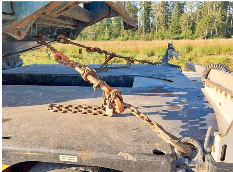
Abbildung 7: ordentlich verspannte Zurrketten in der Front Quelle: Rainer Mohrlök, ForstBW
