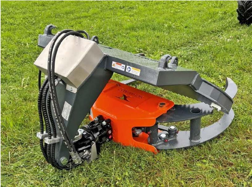
Abbildung 6: Holzladezange in Transportstellung; Quelle: KWF
