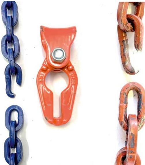
Abbildung 8: Kettenbruch bei symmetrischer Kettenfalle
