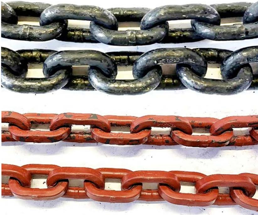
Abbildung 10: gestreckte Chokerketten (oben nach der Belastung, unten Neuzustand)
