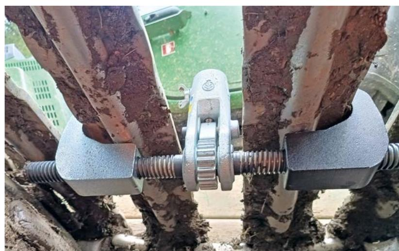
Abbildung 5: Center-Mounting-Tool von Olofsfors; Quelle: KWF
