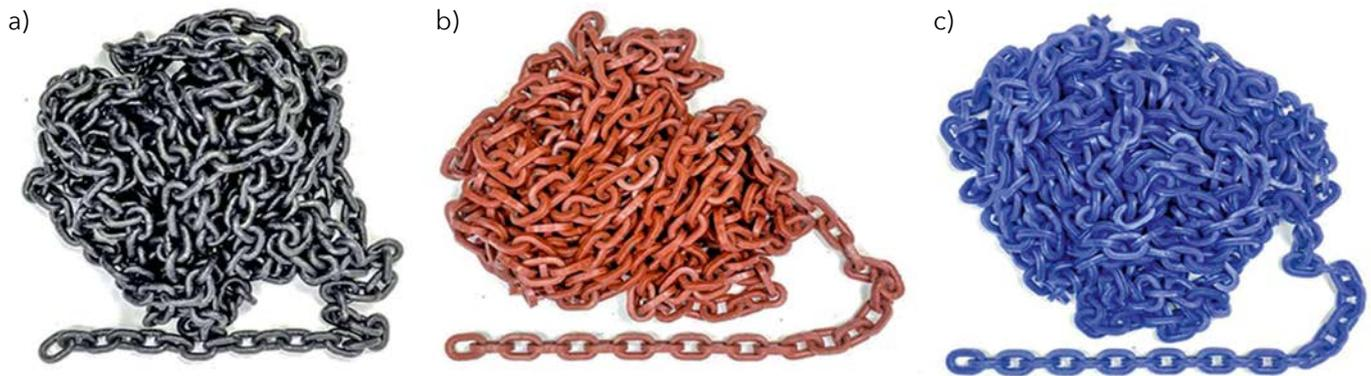
Abbildung 4: Chokerketten für die Versuchsreihe, a) Grad 80 Plus, b) Grad 80, c) Joker V – Grad 100
