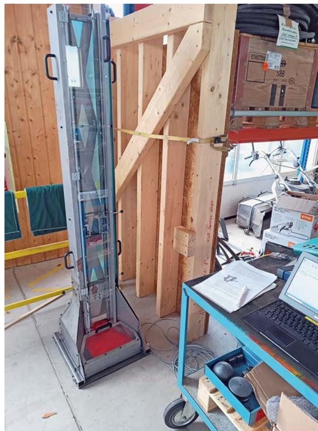
Abb. 2: Der zur Erprobung testweise aufgebaute Prallschutz-Prüfstand, den das KWF für die Erprobung der neuartigen Textil-Gewirke konstruiert hat.
