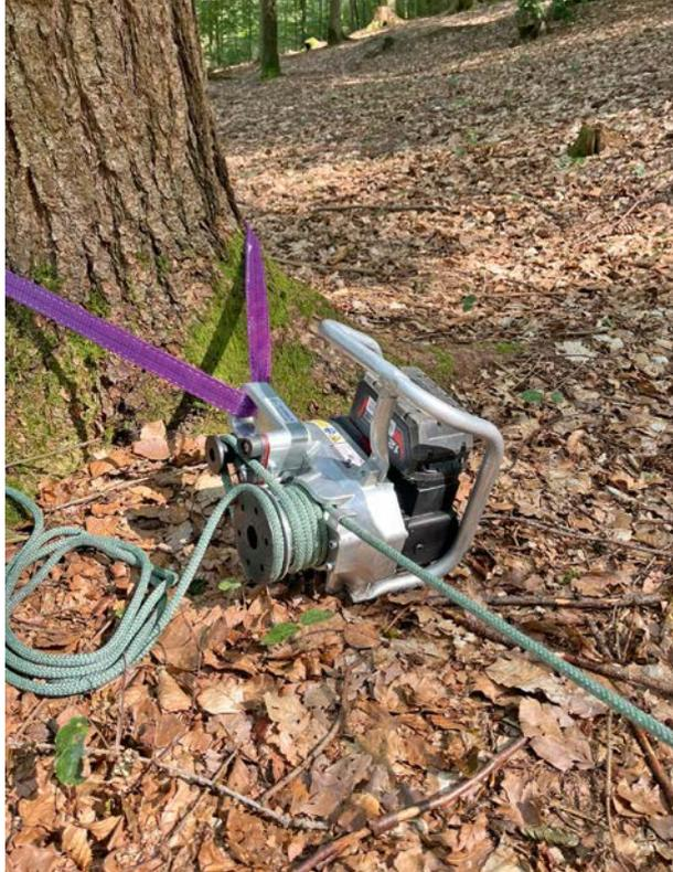
Abbildung 10: Spillwinde SP 1000; Quelle: KWF
