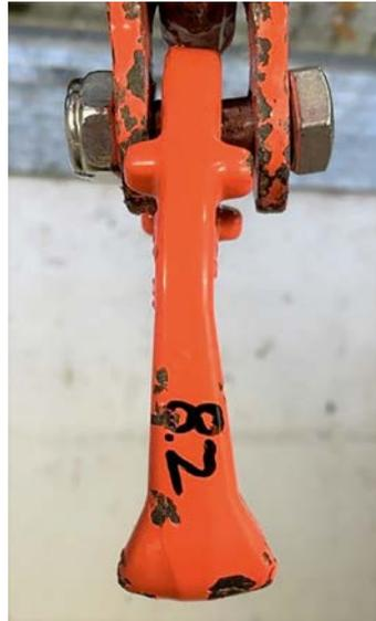
Abbildung 9: Deformationen an einer symmetrischen Kettenfalle
