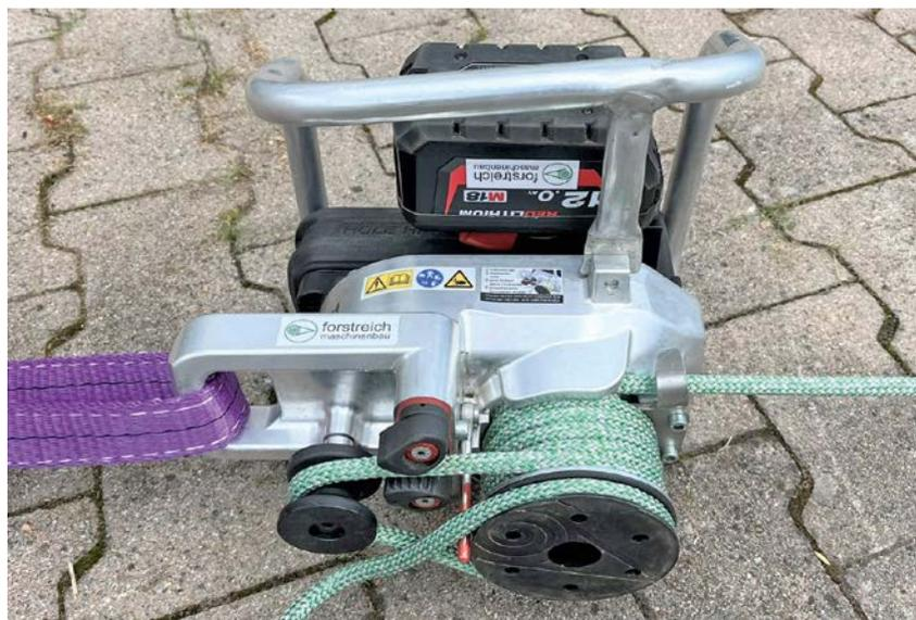
Abbildung 11: Seilführung SP 1000; Quelle: KWF
