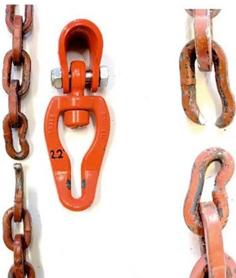
Abbildung 6: Kettenbruch bei abgewinkelter Kettenfalle
