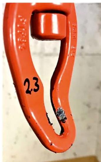
Abbildung 7: Deformationen an einer abgewinkelten Kettenfalle
