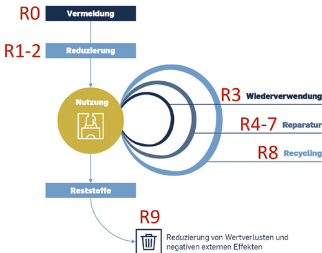
Abbildung 1 Terminologie der Strategien zum Werterhalt von Ressourcen (R). Die R-Strategien sind nach ihrer Fähigkeit geordnet, Kreislaufrfähigkeit zu erreichen, d. h. die Lebensdauer der Ressourcen zu optimieren.
