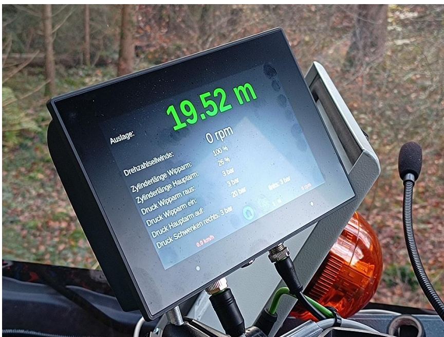
Bildschirm in der Kabine des Fäller-Vorrücke-Fahrzeugs mit Anzeige der Auslage des Krans.
