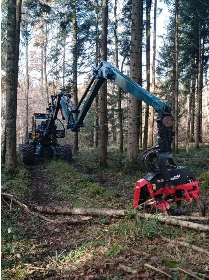
Die Outreach-Maschine mit ausgefahrenem Ausleger im Wald.
