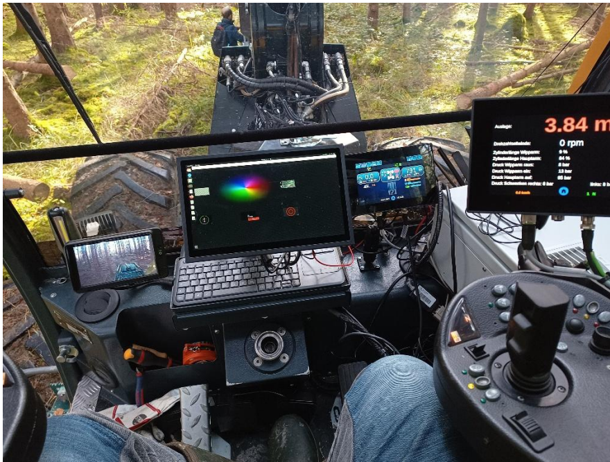
Blick in die Kabine des Outreach Fäll-Vorrücke-Fahrzeugs mit zusätzlichen Bildschirmen des Assistenzsystems.
