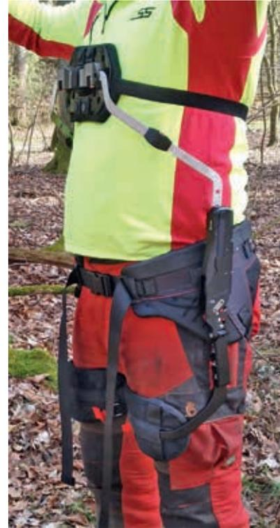
Abb. 4: Passives Exoskelett „BackX“ zur Rückenentlastung (Bild: AWISS)
