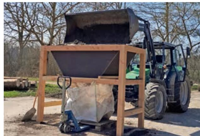
Befüllung der BigBags per Trichter, eine sehr effiziente Methode
