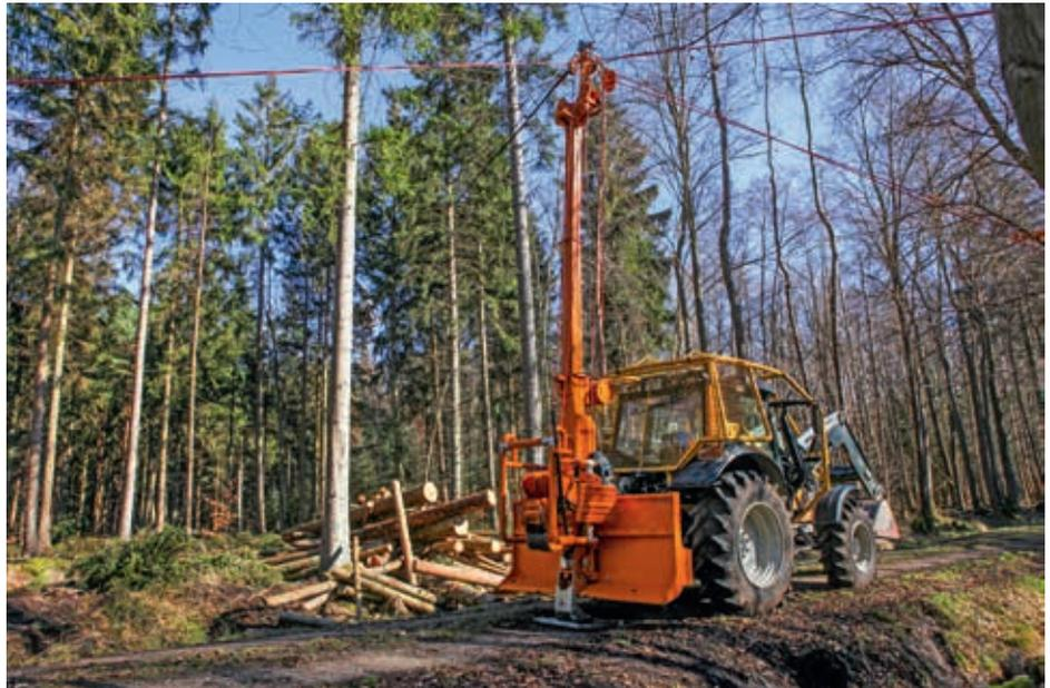
Abb. 2: Kurzstreckenseilkran Ritter KSK 3 S70 und Forstschlepper mit mind. 50 kW Motorleistung als Trägerfahrzeug (Foto: Gabriel)
