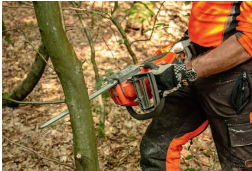
Abb. 5: Absetzen des zu entnehmenden Baumes mit der Akkumotorsäge
