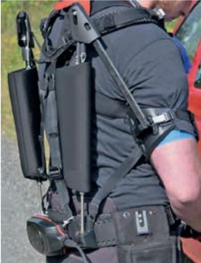
Abb. 2: Passives Exoskelett „PAEXO Shoulder“ zur Schulterentlastung (Bild: AWISS)
