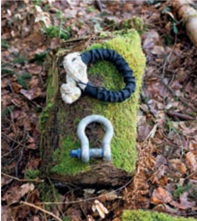
Abb. 6: Im direkten Vergleich: Tauwerk- schäkel (400 g) und Metallschäkel (2,2 kg) (Bildquelle: FBZ Königsbronn)
