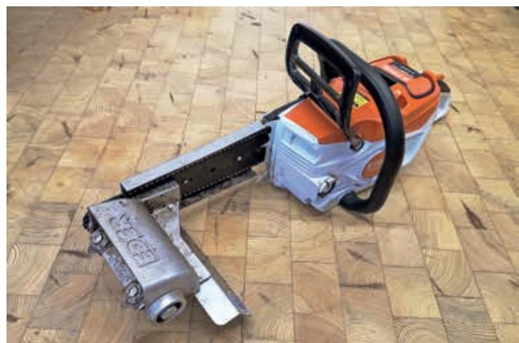
Abb. 2: Eder Schälgerät mit Kettenantrieb und Streifenmessern an Stihl MSA300 (Foto: T. Hase, LWF)
