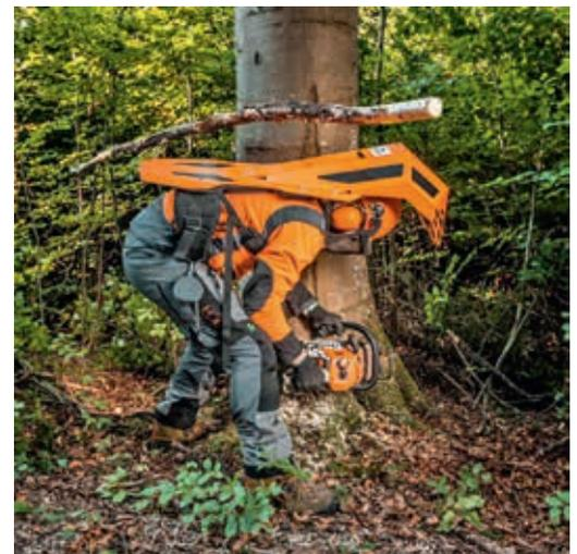
Einsatz des Kopf-Nacken-Rücken-Schutzpanzers VinZent bei der Holzernte (Foto: BaSt-Ing)
