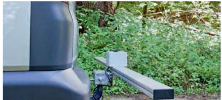
Abb. 2a und b: An einem Fahrzeug montierte sensorbasierte Lanze
