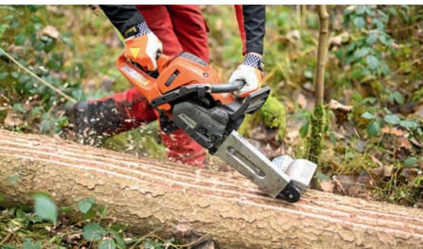
Abb. 1: Eder Schälgerät mit Kettenantrieb und Streifenmessern im Einsatz an Husqvarna 560 XPG (Foto: T. Hase, LWF)
