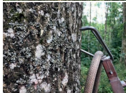
Abb. 8: aufgestellte Teleskopstange mit Sicherheitskralle (Bildquelle: FBZ Königsbronn)
