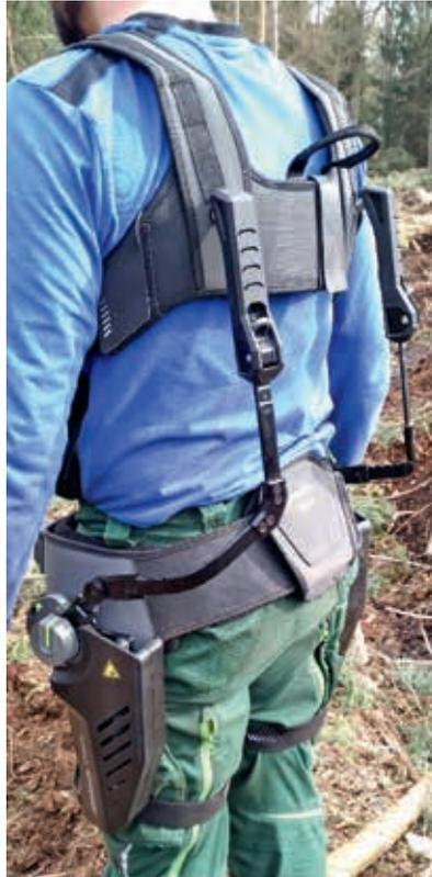
Abb. 3: Passives Exoskelett „PAEXO Back“ zur Rückenentlastung (Bild: AWISS)
