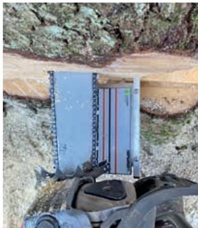
Anschließend wird an der Markierung eingestochen und parallel der passenden Linie der Fällfahne in den Baum ein und durchgestochen und zunächst die Bruchleiste ausgeformt und zum Stützband (Sicherungsband) vorgeschritten. Bei dickeren Bäumen nun die Seite wechseln und wiederum Bruchleiste/Bruchstufe markieren. Anschließend Fällfahne einlegen und Bruchleiste fertig ausformen und anschließend Stützband fertig ausformen.
