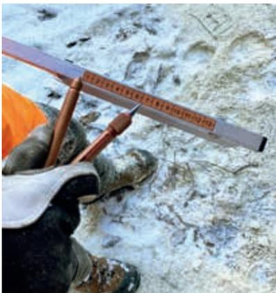
Nach dem Beischneiden der Wurzelanläufe und Anlage des Fallkerbs, wird der Fällzirkel auf das entsprechende Maß ableitend des BHD des zu fällenden Baumes eingestellt. Um die schräge Holzfaser auszugleichen, sollte die Bruchleiste mehr als 10 % betragen. Dabei ist eine Obergrenze von 15 % zwingend einzuhalten.
