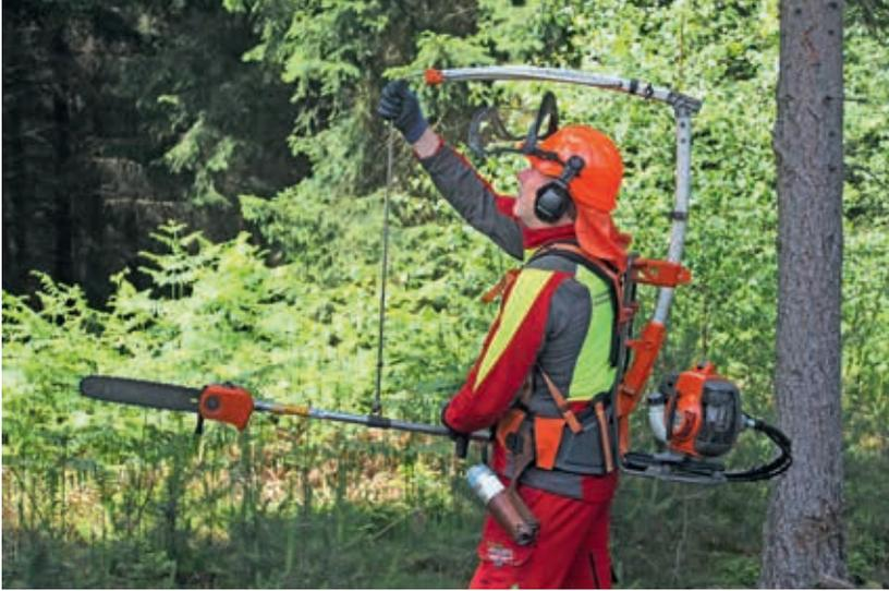
Außerdem wird beim „Spacer“ die Hauptlast auf dem Rücken getragen. Die eigentliche Schneidgarnitur ist an einem tragenden „Galgen“ befestigt und entlastet die Hand-Arm-Muskulatur fast vollständig von semistatischen Kräften, so dass sich der Bediener bzw. die Bedienerin nahezu ausschließlich auf die zu steuernden Bewegungen konzentrieren kann.
