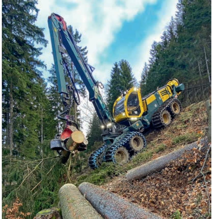
Harvester mit Bogiebändern über den Reifen beider Achsen und Traktionswinde im Steilhang (Foto: HSM, Erik Rieche)
