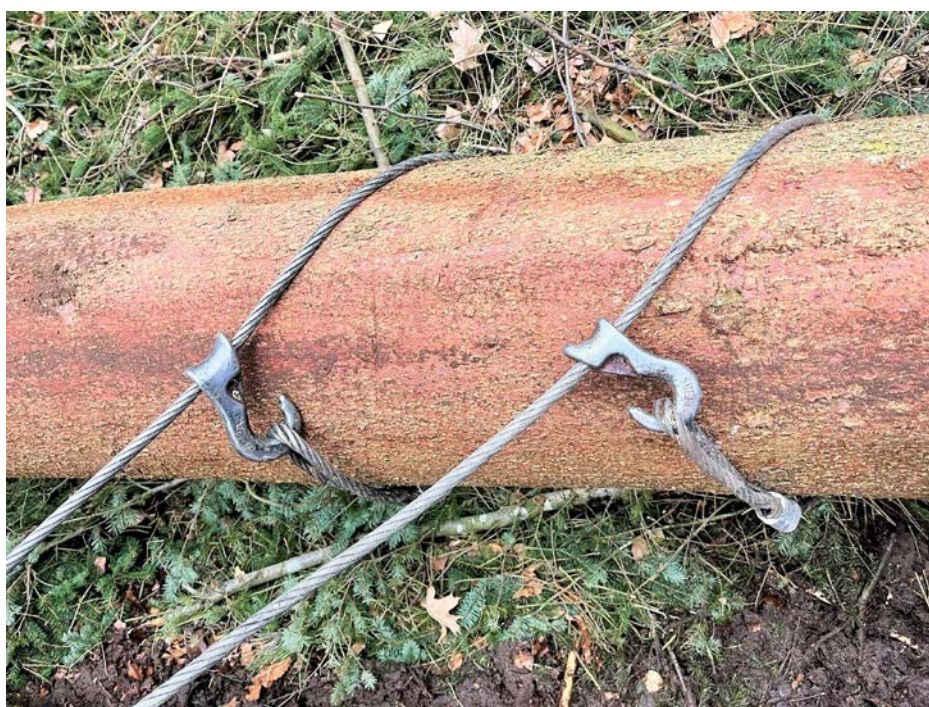
Abbildung 10: Angeschlagene Seilgleithaken, welche unterschiedlich montiert sind und über keine Verschlussklinke verfügen (© Lippert, KWF)
