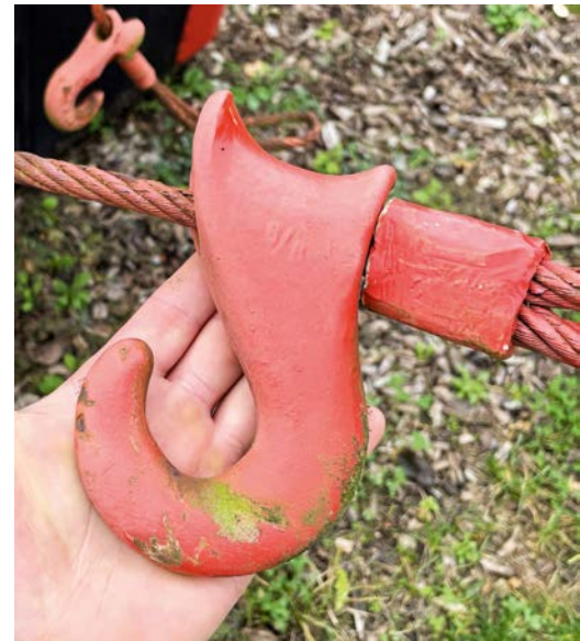
Abbildung 12: Seilgleithaken älterer Bauart ohne Kennzeichnung und eine nicht normgerechte Verpressung. Verwendung wird nicht mehr empfohlen. (© Lippert, KWF)
