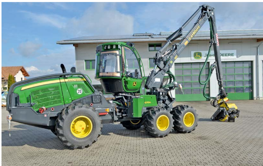
Bild 6 Harvester John Deere 1070 G mit Aggregat H 212 (Foto Weise)
