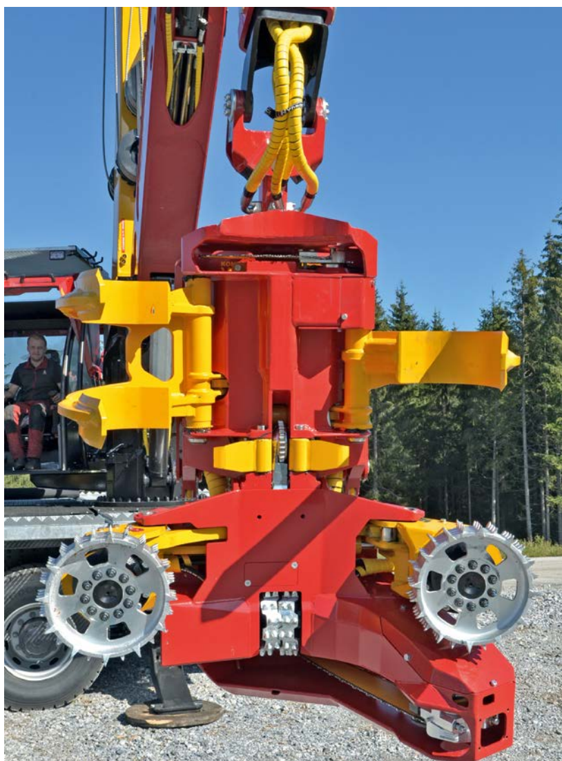
Bild 10 Aufarbeitungs-, Lade- und Sortieraggregat Konrad Woody H 60-1 (Foto Weise)
