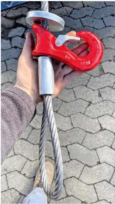
Abbildung 6: Korrekt montierter Seilgleithaken (© Lippert, KWF)
