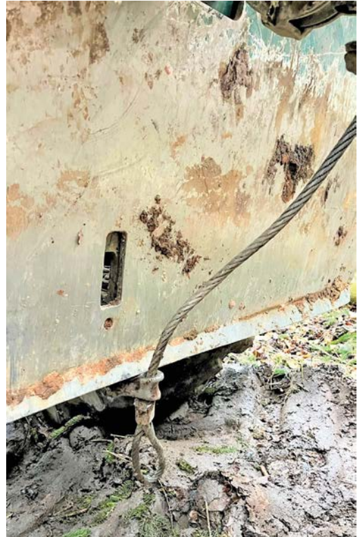
Abbildung 3: Seilgleithaken verfängt sich in der Bergstütze (© Lippert, KWF)
