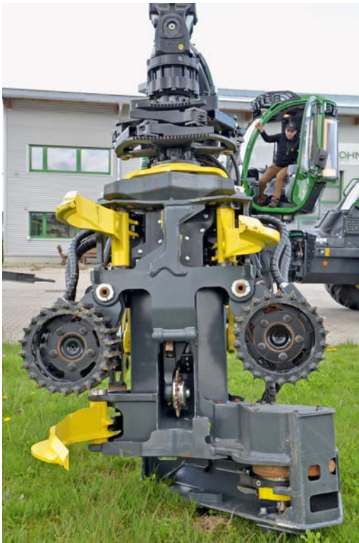
Bild 7 Aggregat John Deere H 212 mit Sammelgreifer (Foto Weise)
