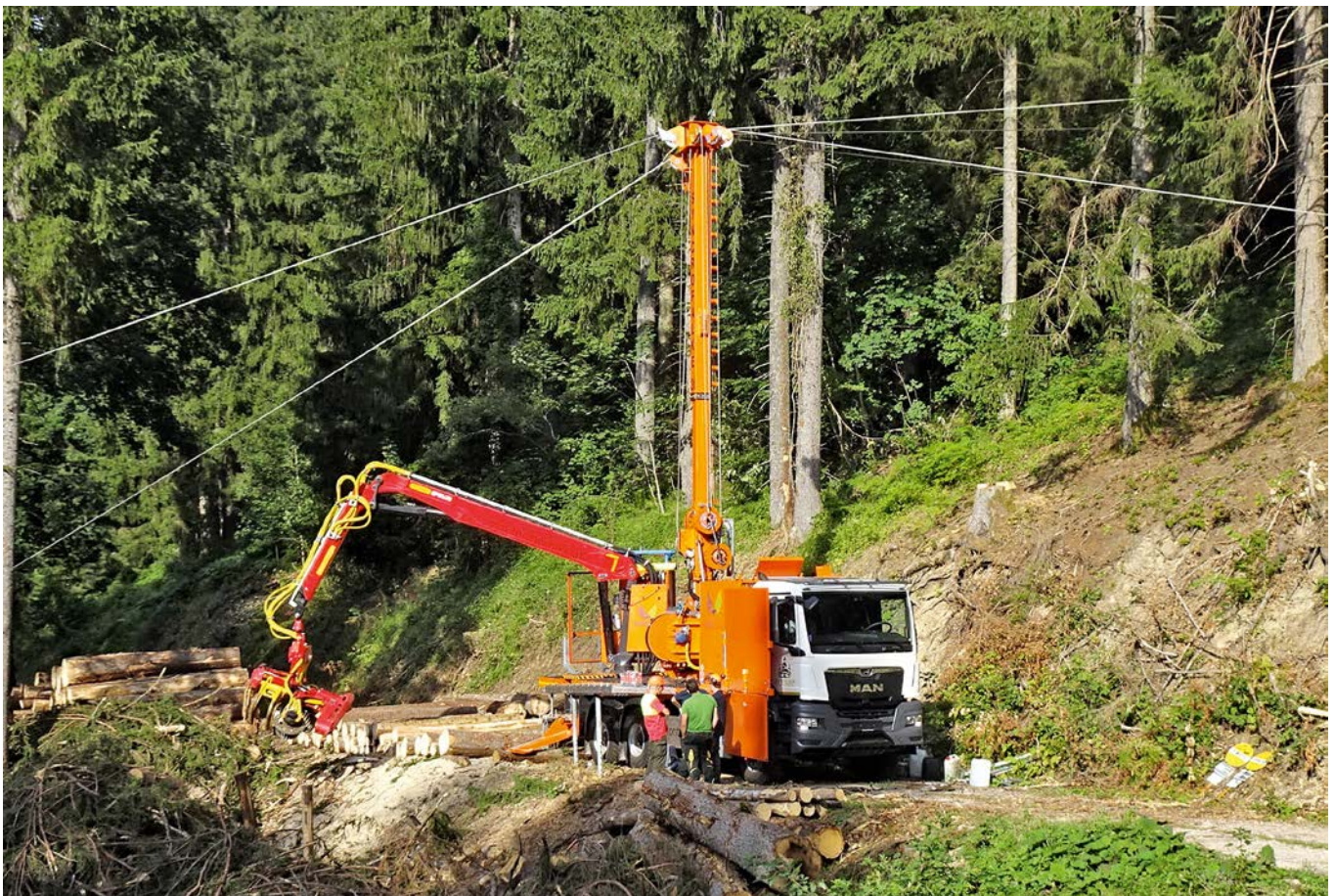
Bild 8 Kombi-Mast-Seilbringungsgerät Mayr Melnhof-Syncrofalke-U-3 t Telemast (Foto Nemestothy)
