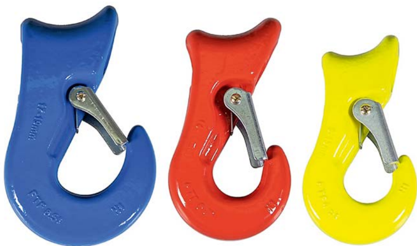
Abbildung 8: Seilgleithaken unterschiedlicher Baugröße mit FTF-Färbung nach Grube Forst (Lastgrenzen: blau = 8,5 t, rot = 6,0 t, gelb = 4,5 t), (Quelle: Grube Forst KG)
