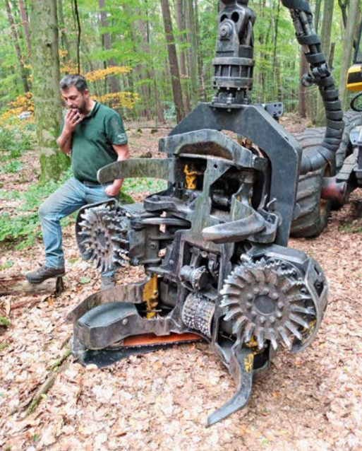
Großes Harvester -Aggregat für-Durchmesser bis ca. 80 cm
