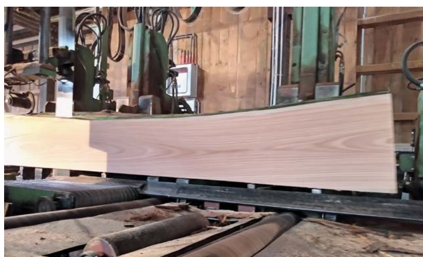
Die Blockbandsäge sägt eine Roteiche in Bretter auf
