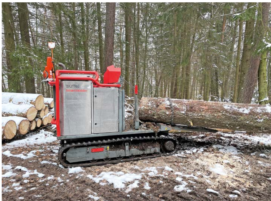
Bild 3 Fernbedienbarer Kompaktgeräteträger Suffel Smart Skidder (Foto Lippert)
