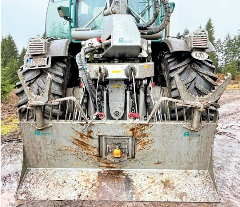
Abbildung 2: Doppeltrommelwinde mit verkehrt herum montiertem Seilgleithaken (© Lippert, KWF)
