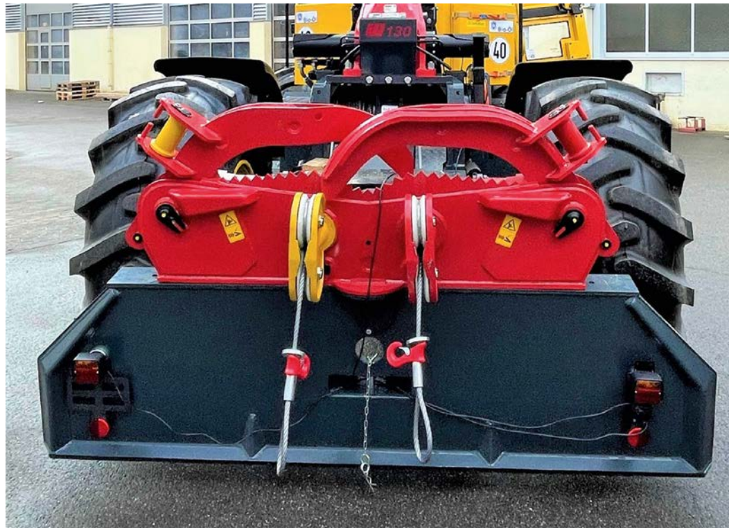
Abbildung 15: Korrekt montierte Seilgleithaken an einer Neumaschine (© Lippert, KWF)
