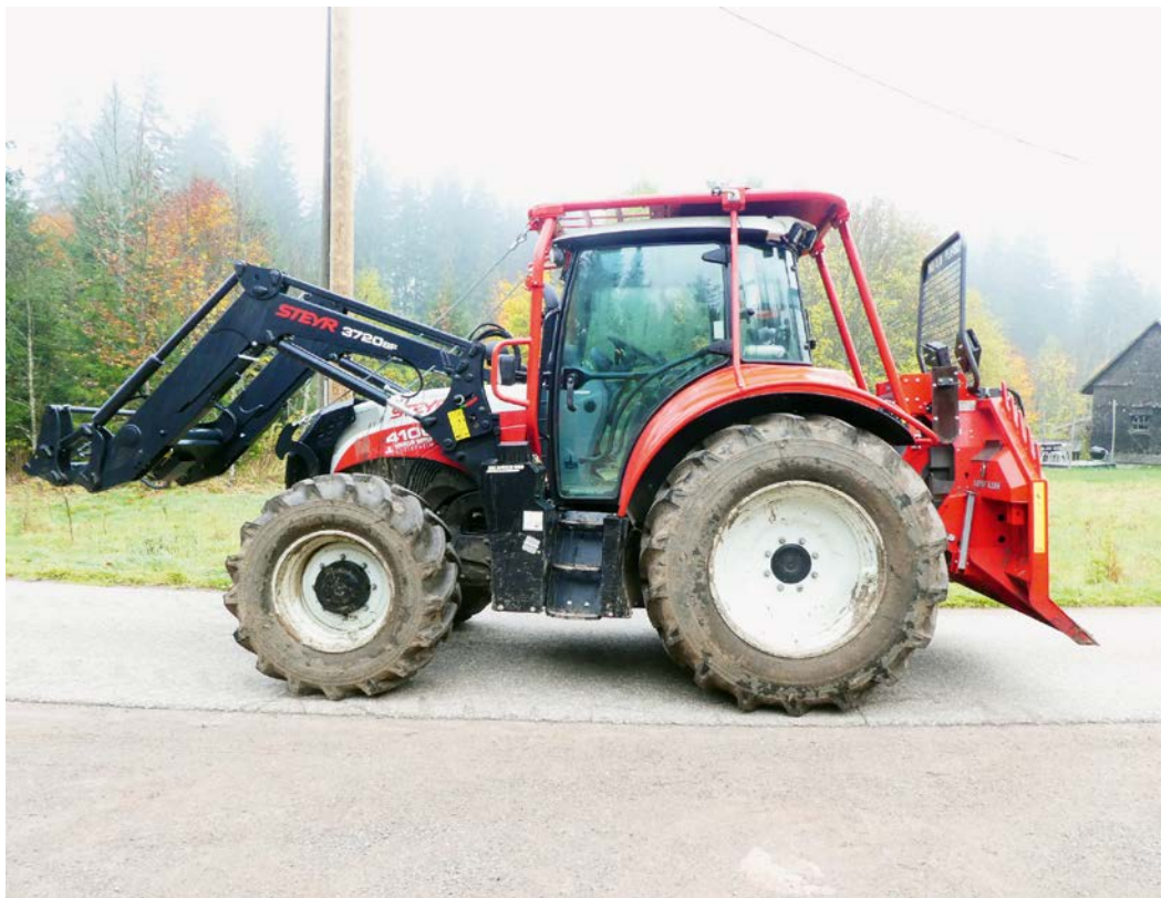
Bild 2 Forstraktor Steyr Multi 4100 (Foto Lenz)
