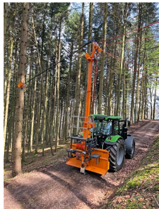
Bild 4 Kurzstreckenseilkran KSK 3 Bauart Ritter (Foto Lippert)
