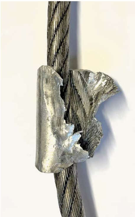
Abbildung 4: Gebrochene Presshülse einer Seilendverbindung (© Lippert, KWF)
