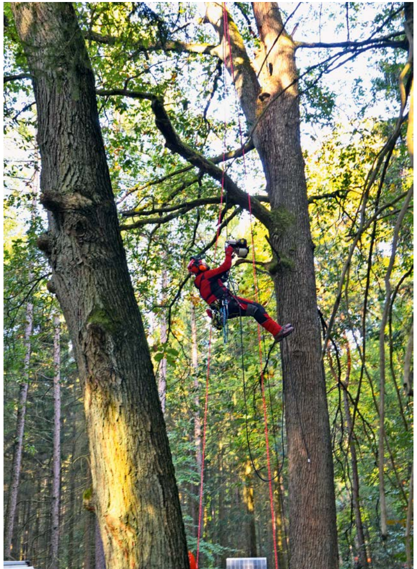
Bild 5: Personenhubwinde zur Erleichterung von Baumsteigerarbeiten (Bild Weise)
