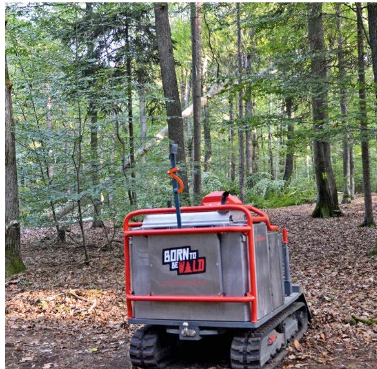
Bild 4: Seilwindenunterstützte Baumfällung mit Kompaktgeräteträger (Bild Weise)
