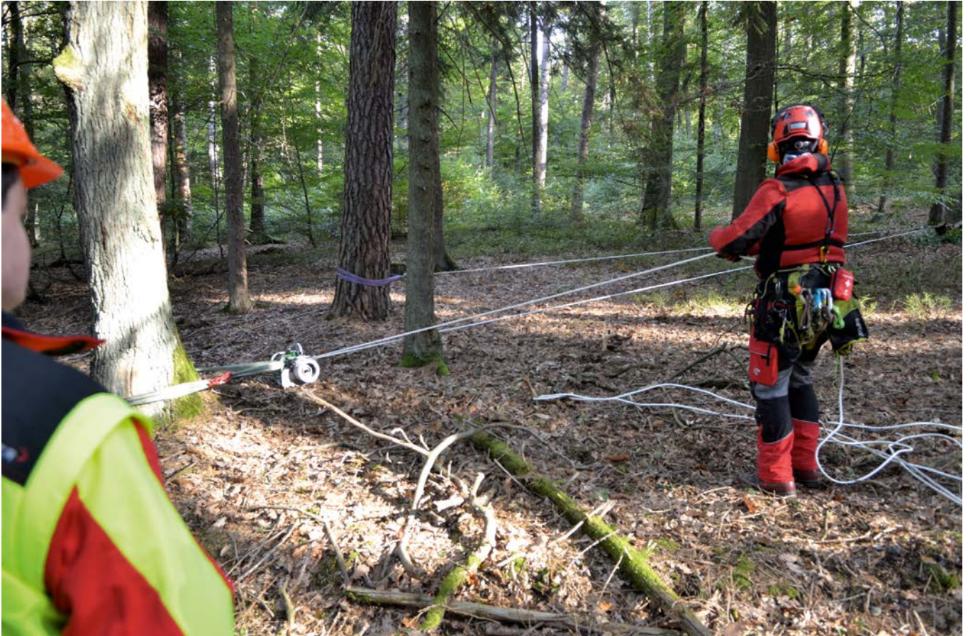
Bild 2: Abziehen eines Hängers mit tragbarer Spillwinde (Bild Weise)
