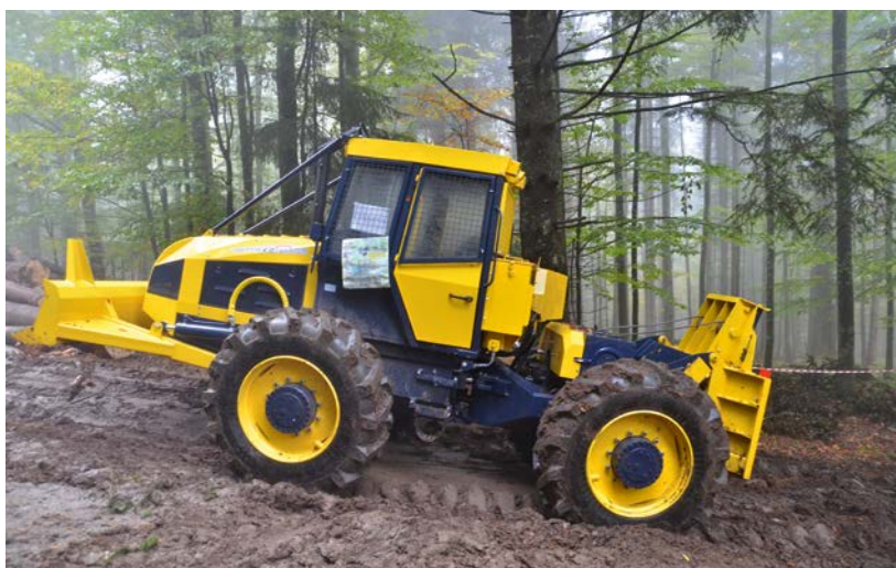
Bild 15 Rückeschlepper als Spezialmaschine ohne Rückenausleger
