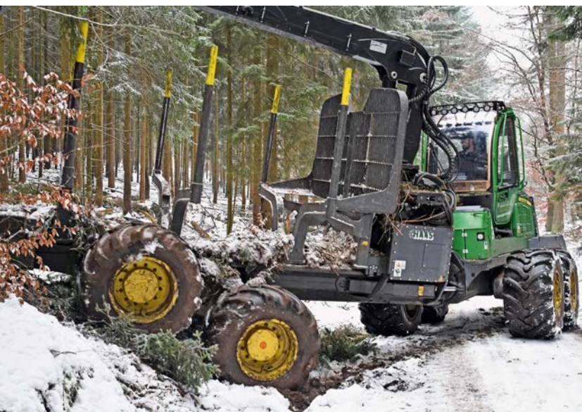
Fährt der Forwarder in die Rückegasse ein, dann ist so herum meist „vorwärts“ – auf dem Waldweg oder der Straße wäre es „rückwärts“
