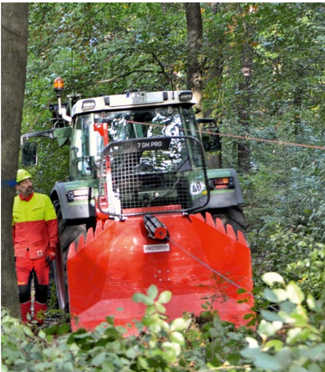
Bild 3: Konstantzugwinde — Seilzug mit aufgebauter Seilzugwinde (Bild Weise)
