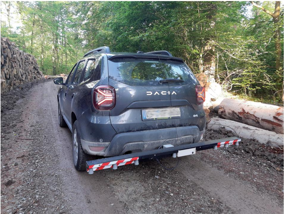
*Fotooptische Erfassung der Wegoberfläche mit einer Messlanze*
