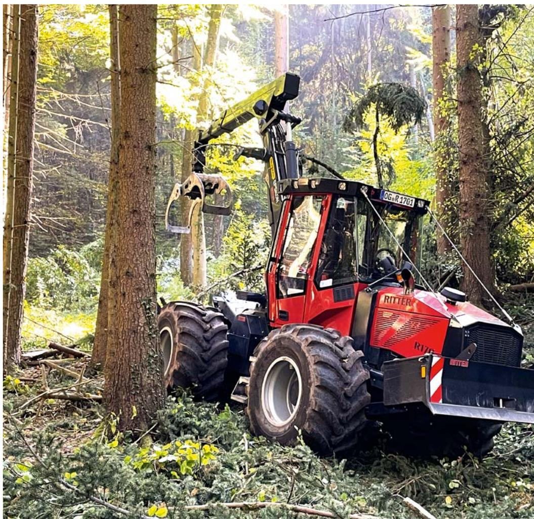
Abbildung 6: Ritter R170 mit einer Aufbauseilwinde mit konstanter Seileinzugskraft (Abbildung K. Lippert)
