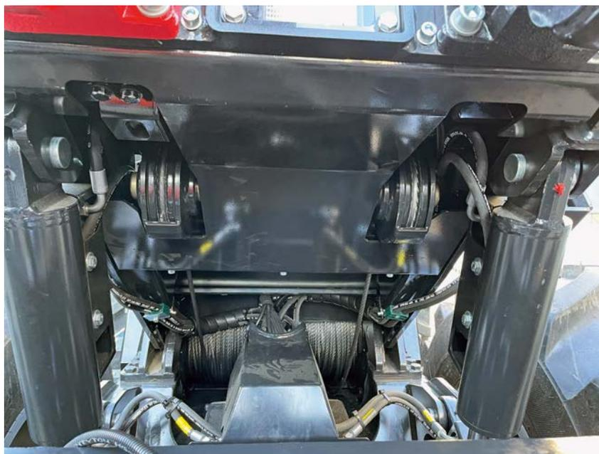
Abbildung 5: Umlenkrollen mit Kraftmessbolzen und Doppeltrommel an einem Skidder (Abbildung K. Lippert)
