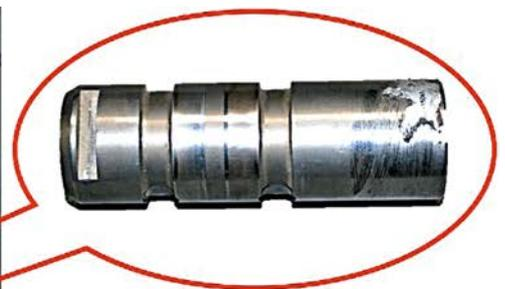
Abbildung 7: Kraftmessbolzen zur Messgrößenbestimmung der Seileinzugskraft
