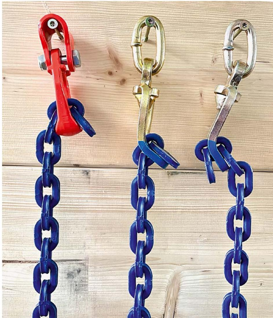
Abbildung 3: Eingehängte Kette; links richtungsunabhängige Kettenfalle; Mitte, Standard Kettenfalle mit korrekt eingehängter Kette; rechts, Standard Kettenfalle mit falsch eingehängter Kette
