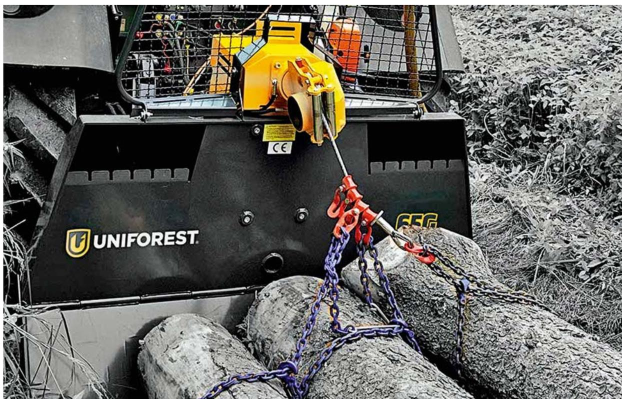
Abbildung 1: Kettenfallen an einer Forstseilwinde
