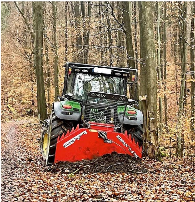
Abbildung 1: Anbauforstseilwinde mit konstanter Zugkraft, Foto: Lippert
