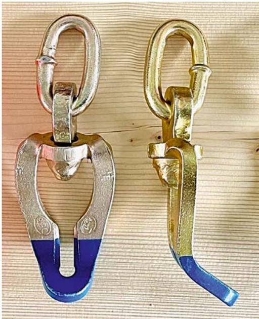
Abbildung 2: Standard-Kettenfalle mit Wirbel
