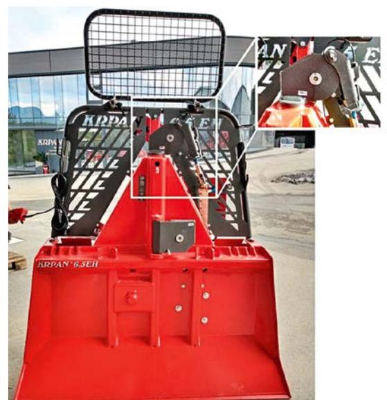
Abbildung 1: Forstseilwinde mit Seilendabschaltung (Bild: Lippert)
