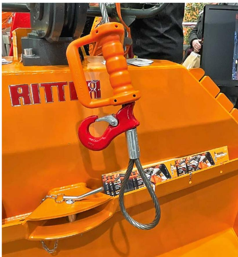
Abbildung 4: montierter Seilgriff SL-PRO Roperunner (Bild: Lippert)
