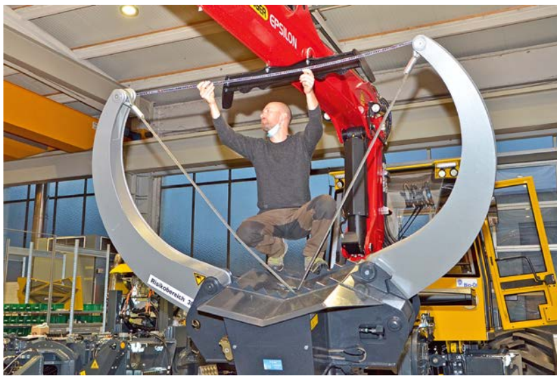
Bild 4 Kombinationsmaschine Welte Typ „W 130 K“ Langholzkonfiguration (L) – Klemmbank der Bauart Burger 1,1 m² KS zum Langholzrücken (Foto Weise)
