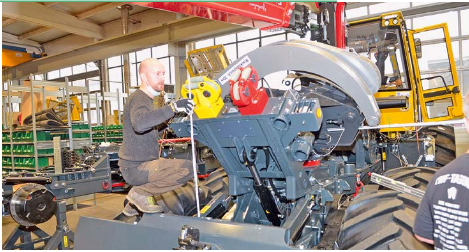
Bild 3 Kombinationsmaschine Welte Typ „W 130 K“ Langholzkonfiguration (L) – hochstellbarer Rollenbock der Seileinlauffrollen (Foto Weise)
