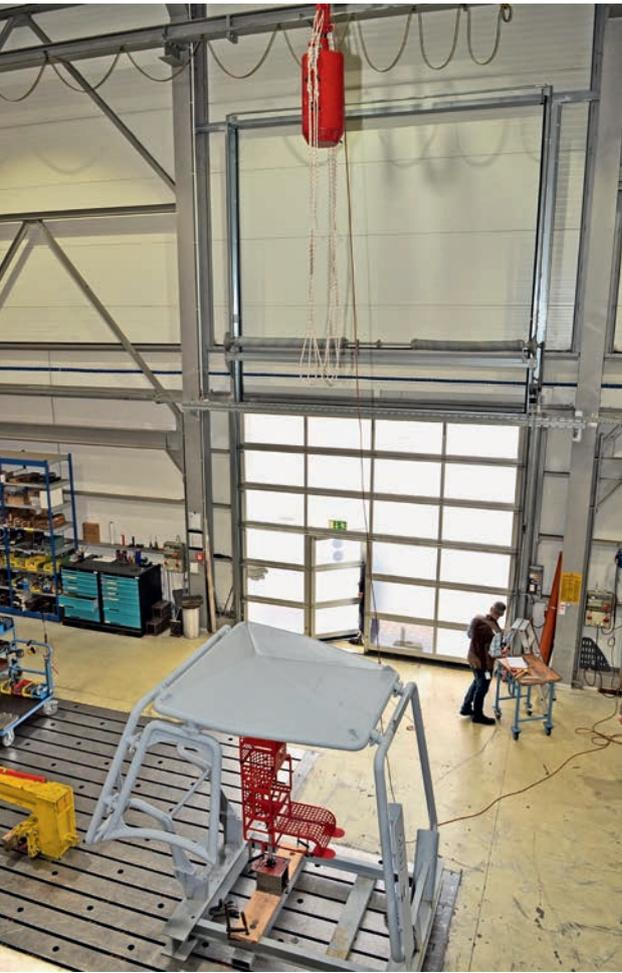
Bild 2 Prüfaufbau FOPS für die Einschlagenergie von 11600 J
