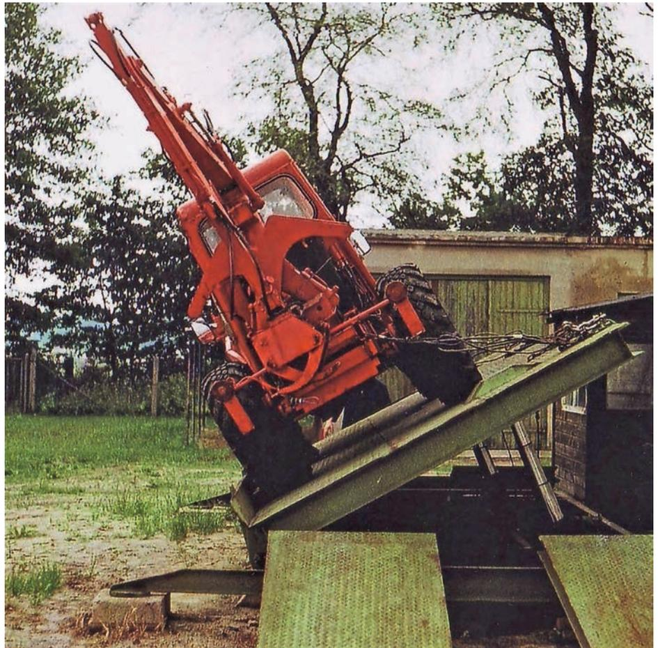
Abb. 2: Rücketraktor LKT 81 Turbo vor Bremsfahrzeug Tatra bei Zugkraftuntersuchungen
