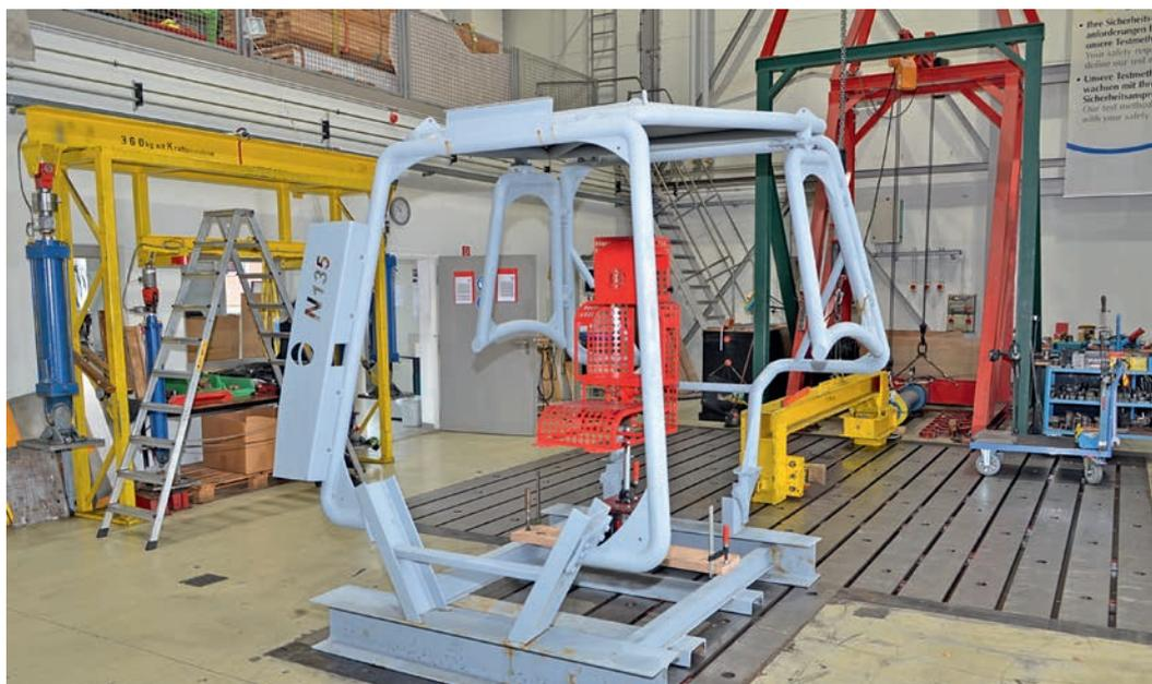
Bild 1 FOPS-Schutzaufbau für Traktoren der Valtra N-Serie
