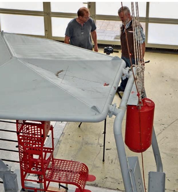
Bild 3 Einschlagstelle auf dem FOPS-Schutzaufbau der Agropartner Land- und Forsttechnik GmbH nach dem Prüfeinschlag mit 11600 J
