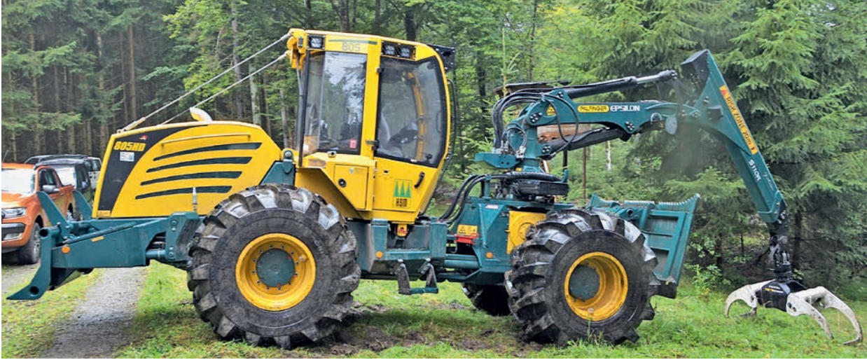
Bild 3: Typischer Kranrückeschlepper Bauart HSM (Foto Weise, KWF)
