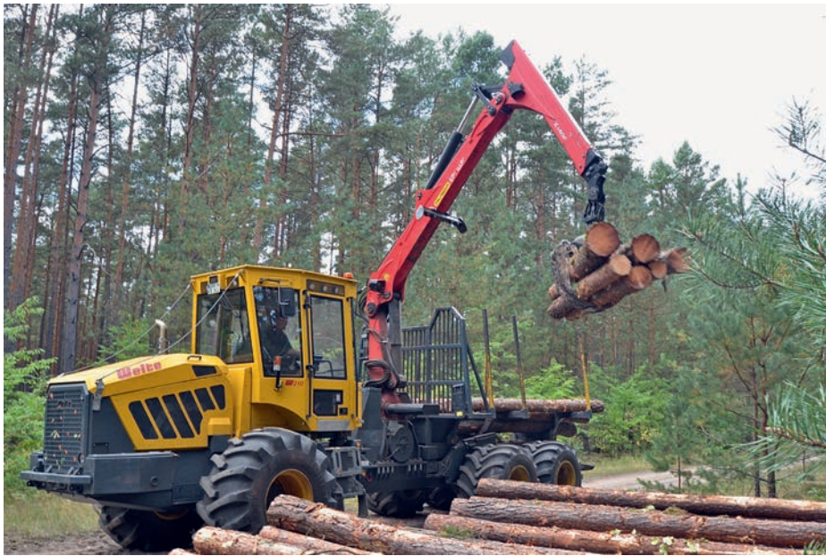
Bild 12: Typische Kombinationsmaschine (Foto Weise, KWF)
