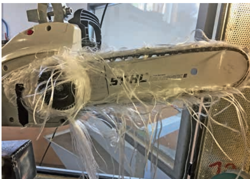
Abbildung 4 Stihl MSE 210 C-BQ nach Schnittversuch
