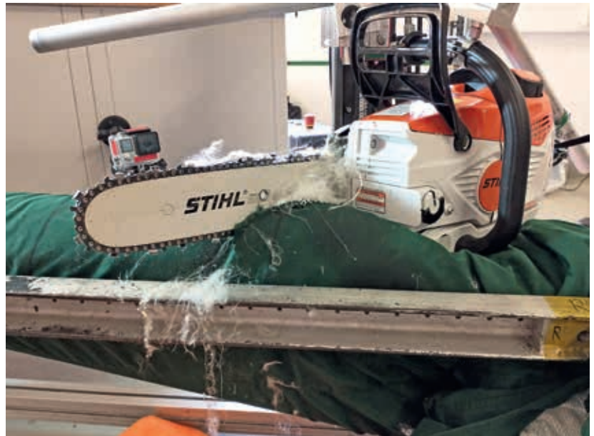
Abbildung 14 MSA 300 Schnittversuch Klasse 3
