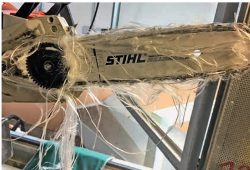
Abbildung 3 Stihl MSA 200 C-BQ nach Schnittversuch
