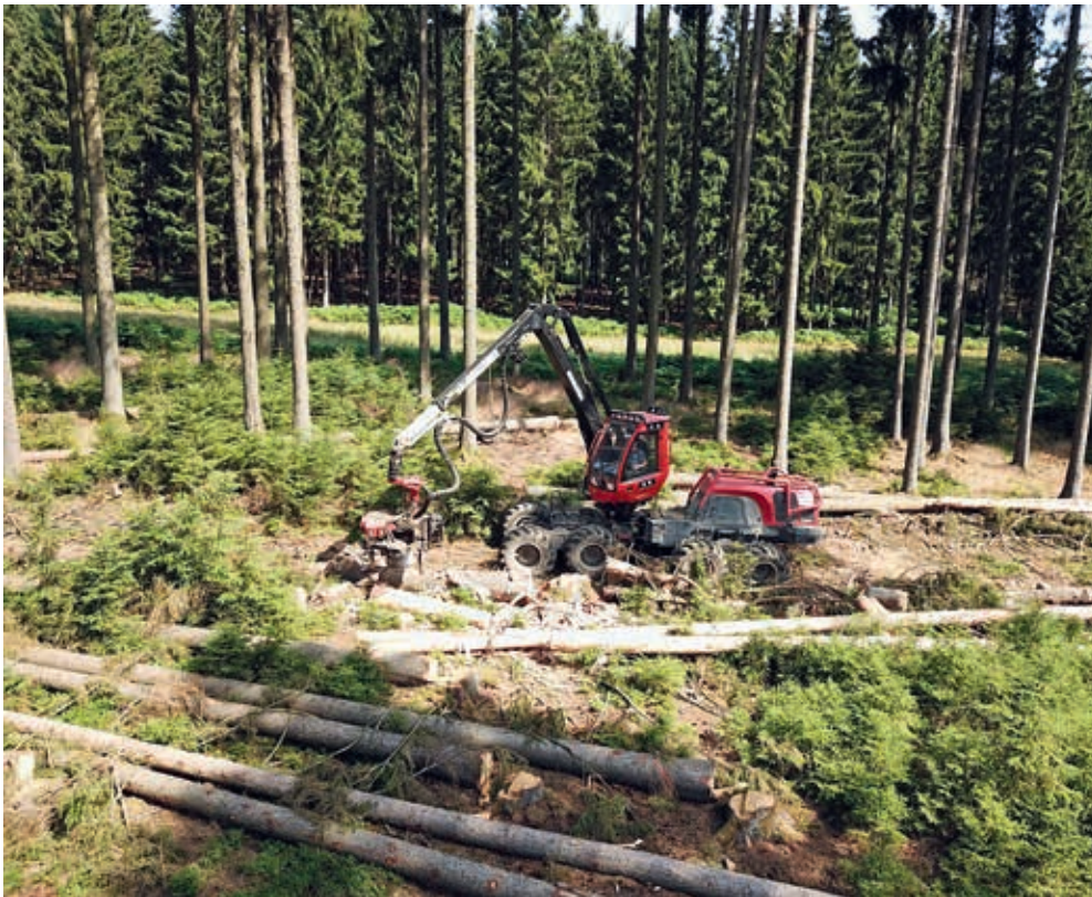
Einsatz eines Debarking Heads bei der Aufarbeitung eines Käferlochs (Lippert)
