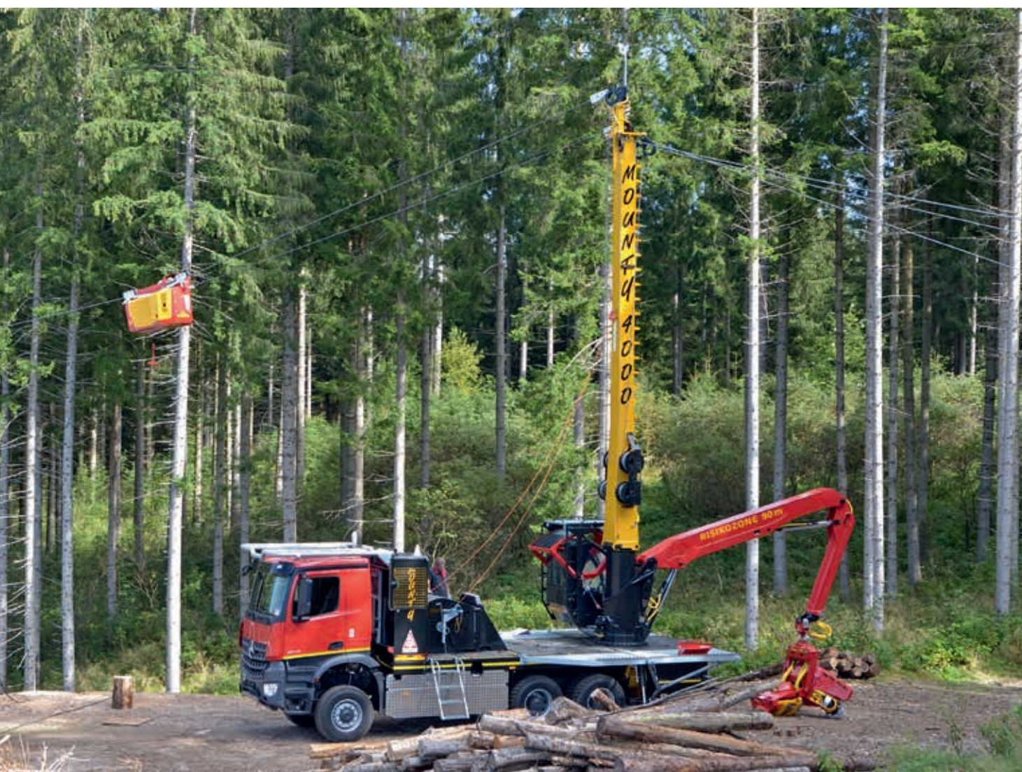
Bild 1 Seilkrananlage (Foto Weise, KWF)
