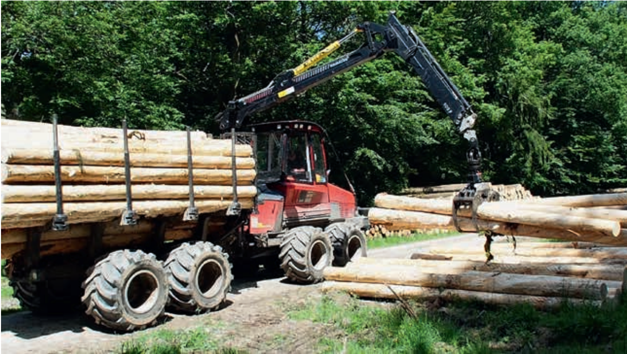
Komatsu 845 beim Poltern von im Bestand entrindeten Abschnitten (Hauck)
