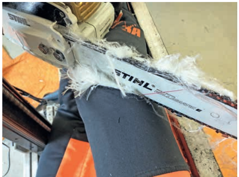
Abbildung 15 MS 261 C-M Schnittversuch Klasse 3
