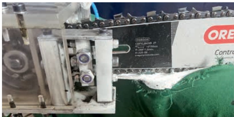
Abbildung 11 Modell „kabelgebunden“ nach Schnittversuch
