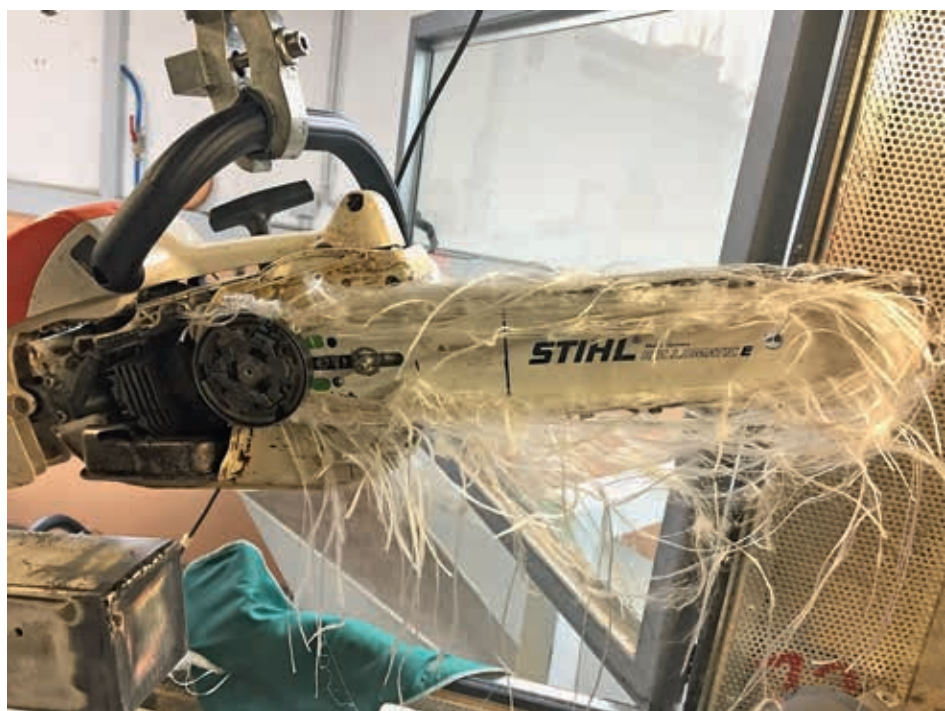
Abbildung 2 Stihl MS 201 C-BQ nach Schnittversuch
