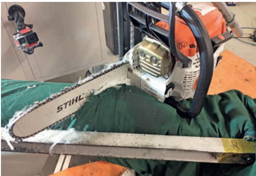
Abbildung 12 MSA 300 Schnittversuch Klasse 1
