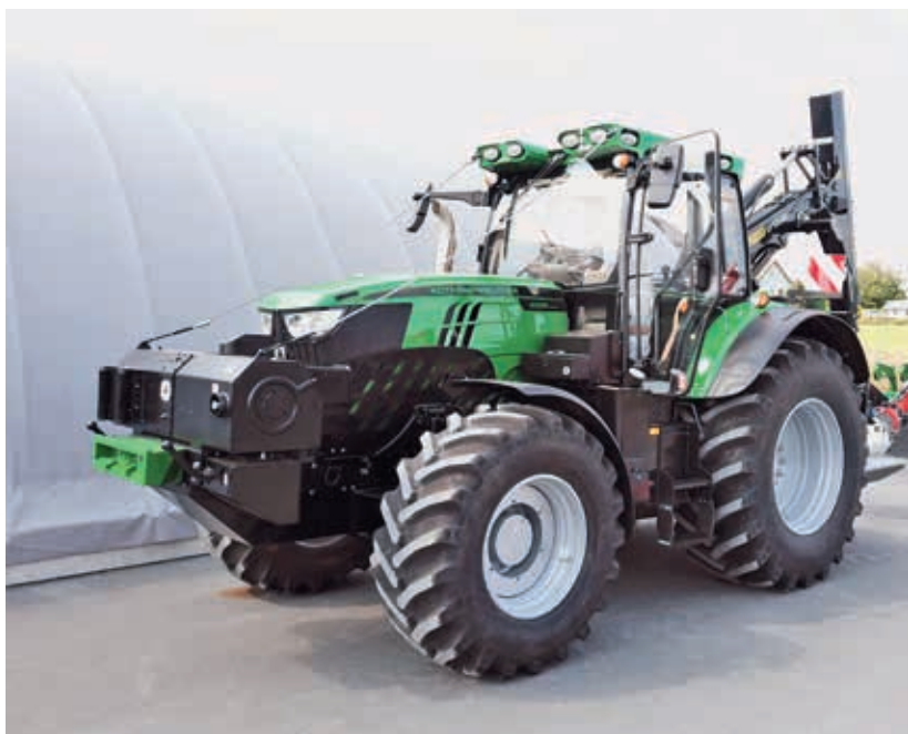
Bild 7 Forstraktor Kotschenreuther Typ „K 220 R Gen. 2“ mit neuer Kabine (Foto Lippert)
