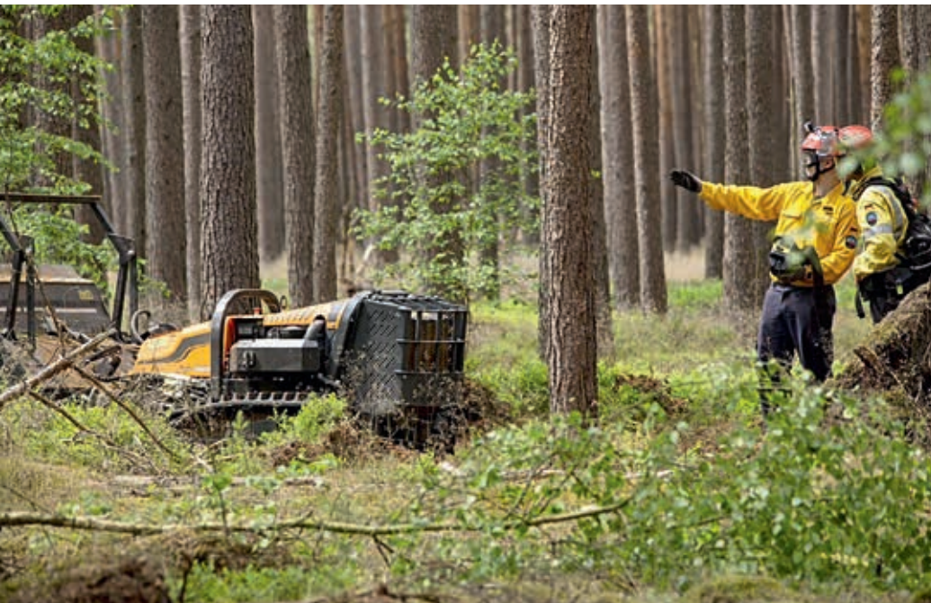
Abb.1. Die Mulchraupe ist vielseitig in der Forst- und Landwirtschaft einsetzbar und ein wertvolles Instrument der Waldbrandvorsorge. Hier im Einsatz an einer WKR-Demonstrationsfläche bei Gartow.
