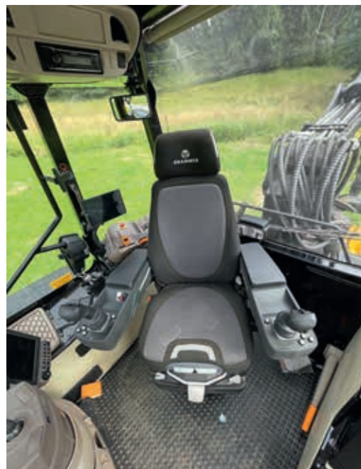
Bild 8 Das Innere der neu entwickelten Kotschenreuther Gen. 2 Kabine (Foto Lippert)
