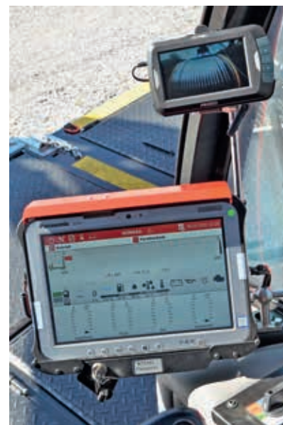
Bild 3 Steuerungssystem Konrad für Mouny 4000 mit Touchpad und Überwachungsmonitor der Aufspulqualität (Foto Weise)
