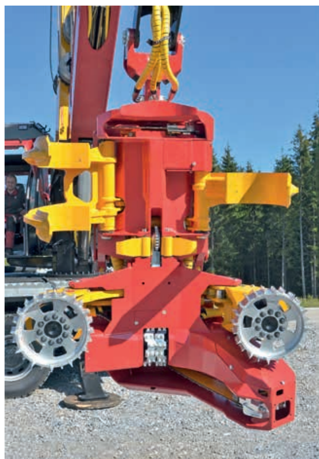
Bild 4 Weiterentwickeltes 3-Walzen Greiferaggregat Konrad Typ „Woody WH 60-1“ (Foto Weise)
