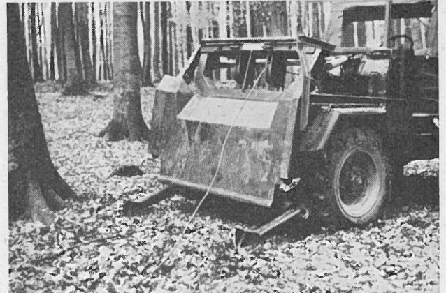
Bild Nr. 7: Unimog und Glogger-Aggregat mit dem nach hiesigen Erfahrungen entwickelten Tragrahmen
