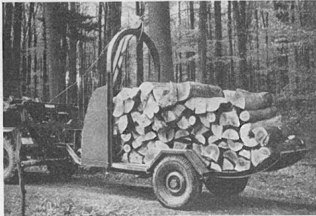
Bild Nr. 5: Einachsrückewagen „Dreieich“ nach Beladung
