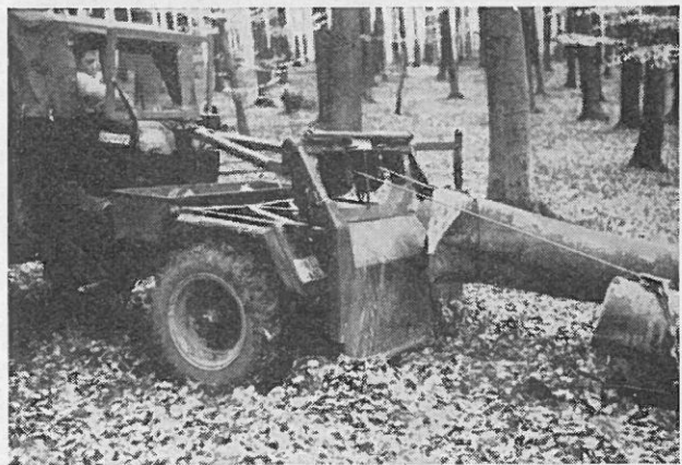
Bild Nr. 4: Die Transportlast wird heran- und hochgezogen
