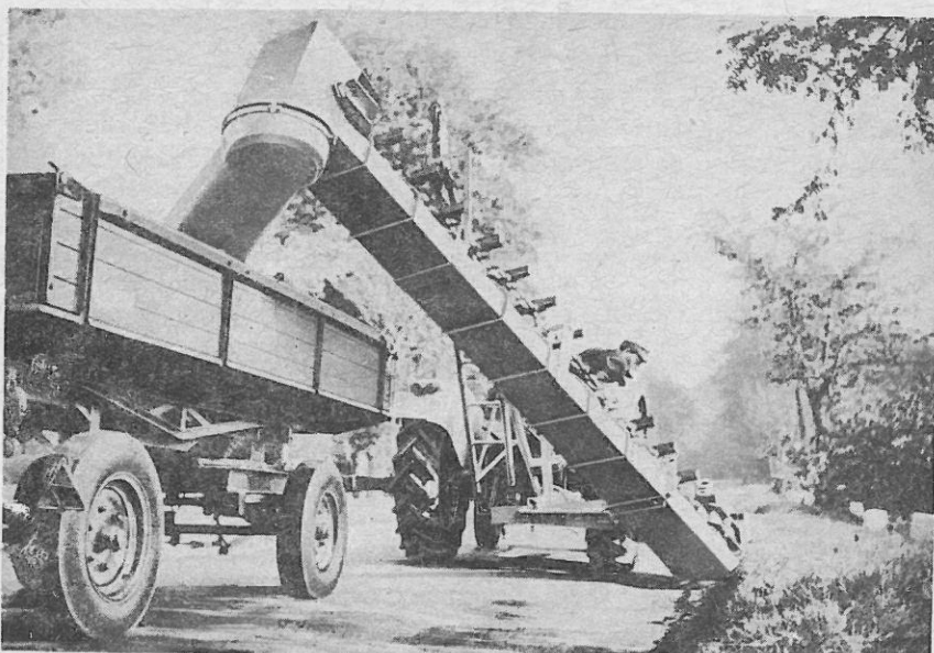
Abb. 2: Banketräumgerät System Kixmüller mit ausgeschwenktem Elevator
