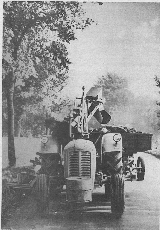
Abb.1: Banketräumgerät System Kixmüller bei der Arbeit
