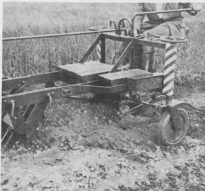
Abb. 22: Das Schar bringt das gelöste Material in die Fahrspur. Seitliche Feineinstellung durch Betätigung des Hebelarmes
