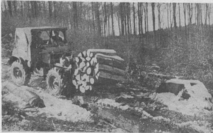
Bild 21: Herausrücker eines Schichtholz Bündels, Anheben mit der Doppelseilwinde zum Unimog
