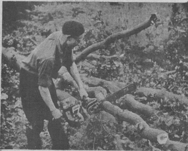
Bild 12: Stark gespannte Hölzer werden von unten geschnitten nachdem der obere Splint durchgesägt ist
