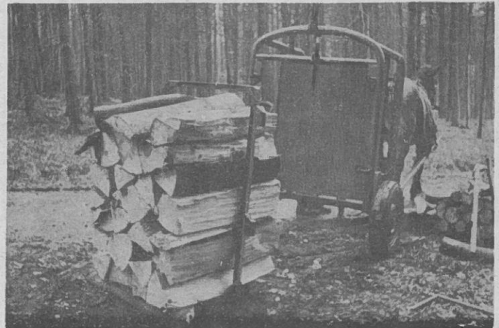
Abb. 12: Mit Spezialrückewagen an Lkw-fahrbare Strasse gerücktes Bündel, das hier mit Hilfe einer am Rückewagen befindlichen Seilwinde abgeladen wurde (Lehrforstamt Gahrenberg).
