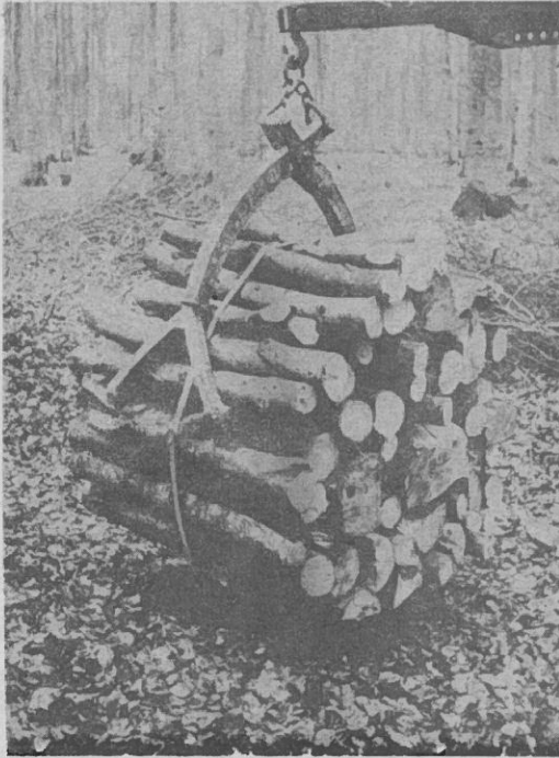
Abb. 7: Wie Abb. 2. Aufnahme eines Bu-Brennknüppelbündels mit der am Hecklader aufgehängten Greifzange.
