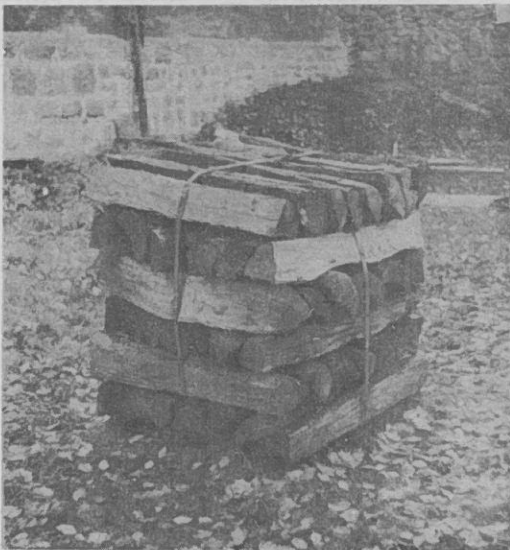
Abb. 9: Bu-Faserholzbündel 1 m lang, 1 rm Inhalt, über Kreuz gestapelt und mit Stahlband doppelt verschnürt.
