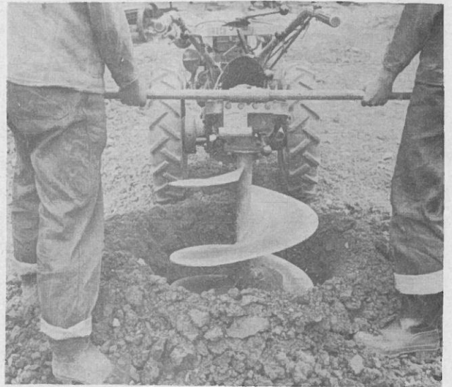
Abb. 6: Eberhard-Pappel-Pflanzlochbohrer hinter Holder-Einachsschlepper 12 PS. Das Pflanzloch wird bis zu 60 cm tief vollständig ausgehoben.
