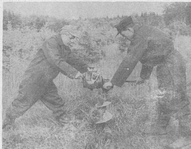
Abb. 8: Stihl-Forstkombination zur BLK mit Spiralbohrer (Pfahlochbohrgerät).
