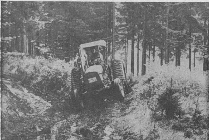
Abb. 15: Der Schlepper muss sich hier selbst eine Rückelinie durch eine Kultur bahnen, da das Freihalten von Rückelinien versäumt worden war.
