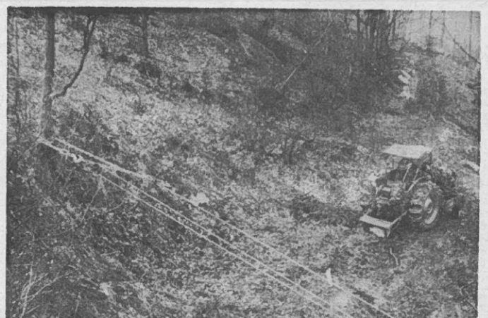
Abb. 18: Der Stamm ist für die Befestigung der Umlenkrolle zu schwach, ausserdem fehlt der Stammschoner. Der Schlepper steht jedoch richtig: Beim Abrutschen der Bergstütze wird er nicht tal- sondern bergwärts gezogen.
