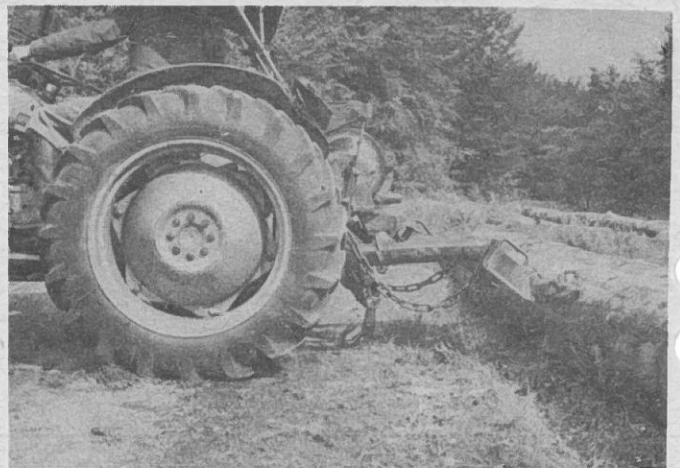
Abb. 20: So soll vielmehr das Holz gelagert werden: Mit der Bergstütze, deren An- griffshöhe sich hydraulisch einstellen lässt. Der Stamm erhöht dabei den Hinterachsdruk und verringert den Schlupf.
