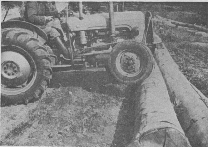
Abb. 19: Schlepper sind keine Zirkuspferde, obwohl man bei Vorführungen sich dieses Eindrucks manchemals nicht erwehren kann. Im Alltag des Holzrückens führt das Lagern und Poltern mittels der Vorderräder zum frühzeitigen Verschleiss des Schleppers.
