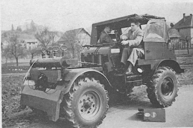
Das komplette Rückeaggregat auf UNIMOG mit langem Radstand mit druckluft-gesteuerter Glogger-Doppelwinde
