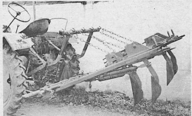
Abb. 6: Hessischer Schwinggrubber für Schlepperzug in Transportstellung
