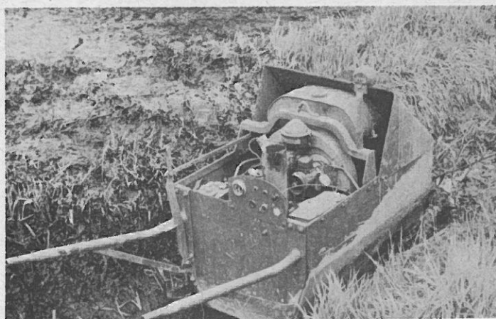
Sohlräumergerät "Grabenfrei". Gleitkörper mit VW-Industriemotor.
