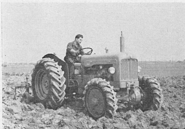
Abb. 2: Radschlepper mit Hilfsantrieb der Vorderachse
