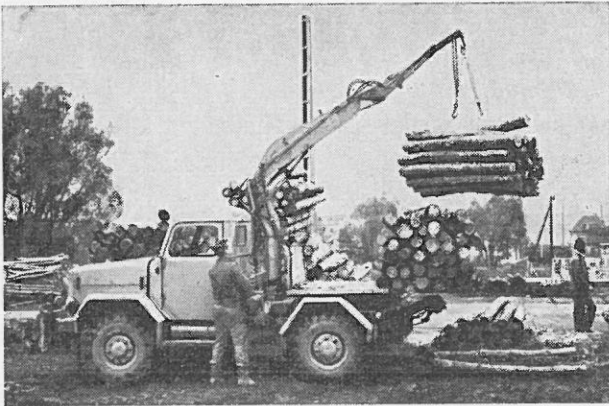
Transport und Verladen von Nadelgrubenholz in losen Seilenschlingen
