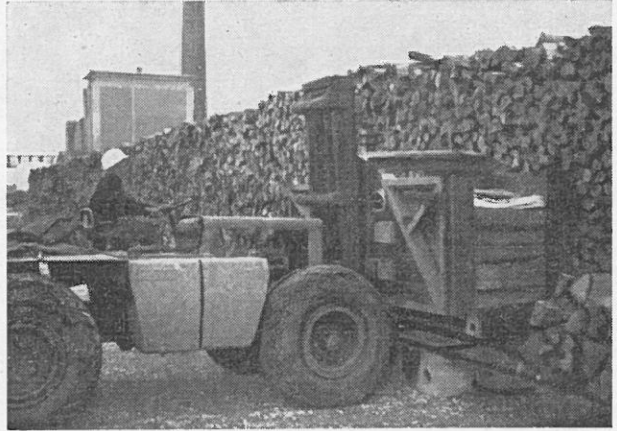
Stapeln von Buchenfaserholz nach Kranentladung aus Waggon
