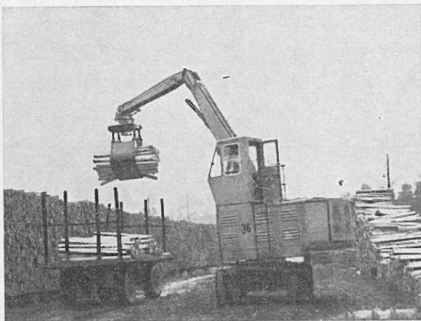
Greiferkran zum Entladen von Buchenfaserholz aus Waggons und zum Beladen von Rollwagen aus Zwischenstapelung
