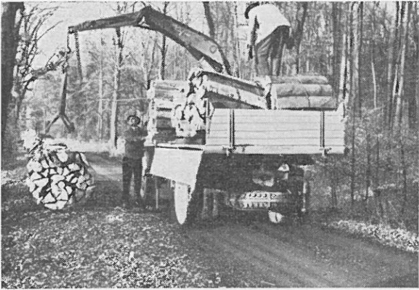
Mit Stahlband gebündeltes Buchenfaserholz. Verladen der Bündel durch Ladekran
