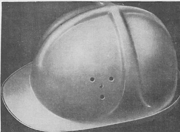
Abb. 4: Schutzhelm in Kappenform aus Pagelastik-Kunststoff mit Regenrinne aus einem Stück; Lüftung durch drei verschliessbare Löcher an jeder Seite; Gewicht mit Innenausstattung 315 g. Fabrikat Presswerk A.-G., Essen.
