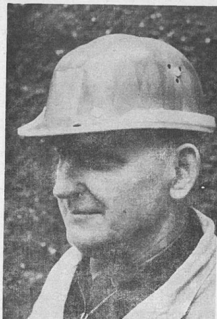
Abb. 3: Schutzhelm in Kappenform aus Phenol-Textil mit fest angesetzter Regenrinne; Lüftung durch drei verschliessbare Löcher an jeder Seite; Gewicht mit Innenausstattung 375 g. Der Helm steht an den Seiten und nach hinten ca. 3 cm vom Kopf ab. Fabrikat Römer, Neu-Ulm.
