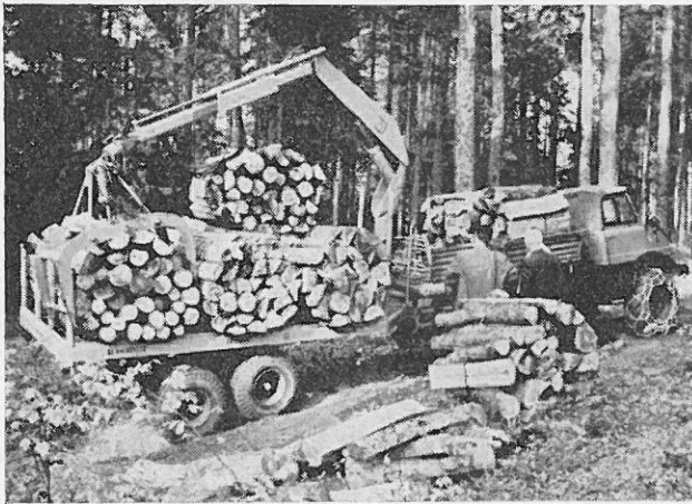
Abb. 10: Rückezug, eine Kombination des Unimog 406 und Ilon-Anhänger 3 L in Verbindung mit Ladekran Hiab 174 und Stabilisator
