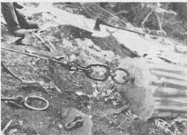
Abb. 1: Mit Hilfe einer Stammschraube an das Windenseil angehängter Stamm
