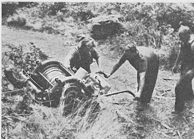
Abb. 3: Überwinden einer steilen Wegböschung beim Instellungbringen der Abseilwinde
