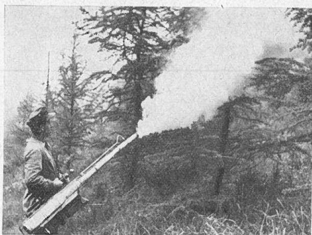
Abb. 4 Schwingfeuernebelgerät im Einsatz. Foto Robertz.
