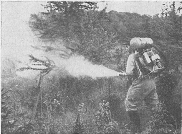
Abb. 2 Rückentragbares Motor-Stäubegerät im Einsatz. Foto Robertz.
