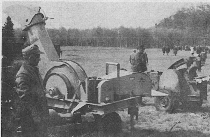
Abb. 8: Kombination von fahrbarer Spaltmaschine mit aufgebautem Motor und Hackmaschine mit Schlepperzapfwellenantrieb; Verladung der Hackschnitzel auf bereitgestellten Anhänger (Hack- und Spaltmaschine: Fabrikat P. Jensen).
