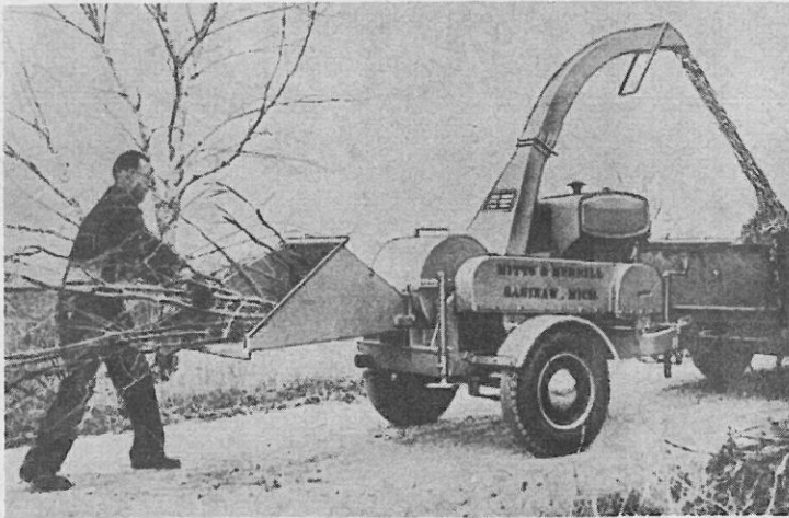
Abb. 5: Fahrbare Holzhackmaschine mit Messerwelle als Einachsanhänger mit aufgebautem Motor hinter einem LKW (Fabrikat Mitts & Merrill).
