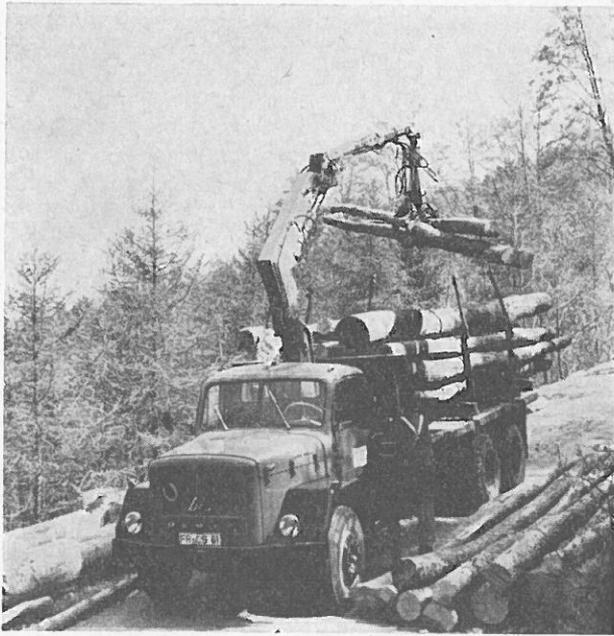
Abb. 2: Diese Aufnahme zeigt das Verladen von Bu-Industrie-hölzern im Bergwald. Das Fahrzeug bringt die Hölzer zur im Tal liegenden Bahnstation. Der Hydraulikkran erlaubt ein schnelles und sicheres Beladen in Einmannarbeit.
