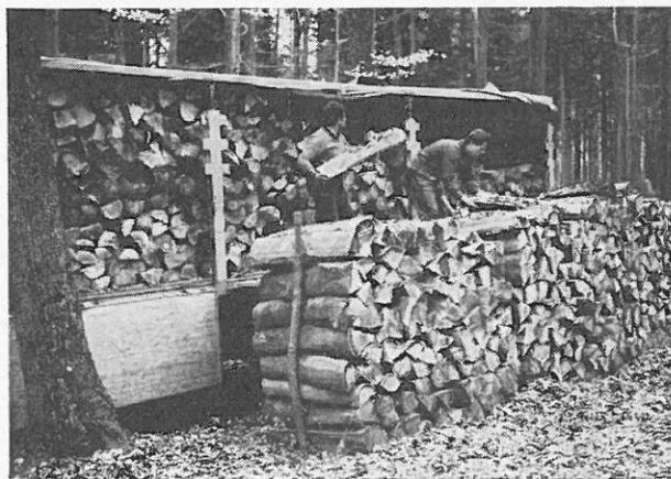
Abb. 1: In dieser Aufnahme kommt der Brennholzcharakter der früheren Form des Bu-Industrieholzes besonders zum Ausdruck. Jedes Stück mußte tragbar sein. Hier wird das Holz auf den Anhänger eines im Ferntransport eingesetzten Großraumlastwagens eingeschichtet. Die Arbeit ist zeitraubend und auch körperlich anstrengend.
