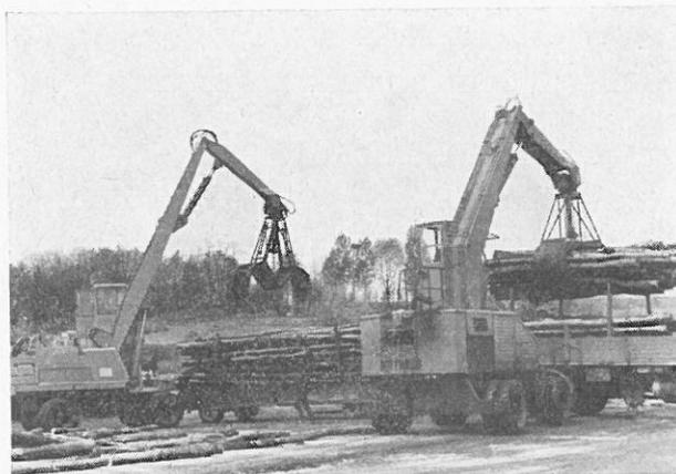
Abb. 5: Aus dem Fernverkehrsbereich laufen sog. Kranlängen ein. Entladen wird mit großen Kränen. Auch hierbei werden nur wenige Minuten benötigt. Der rechte Kran hebt z. B. mit einem Griff die Hälfte der Lademenge des Zugwagens ab. Die Kranlängen können direkt auf den automatischen Vereinzelner der Einschnideanlage geschichtet werden.
