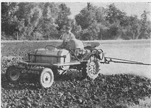
Abb. 8: „KULTIMAX“-Gerät beim Sprühen. Großbaumschule Wolfgang, Aufnahme: Jaburek.
