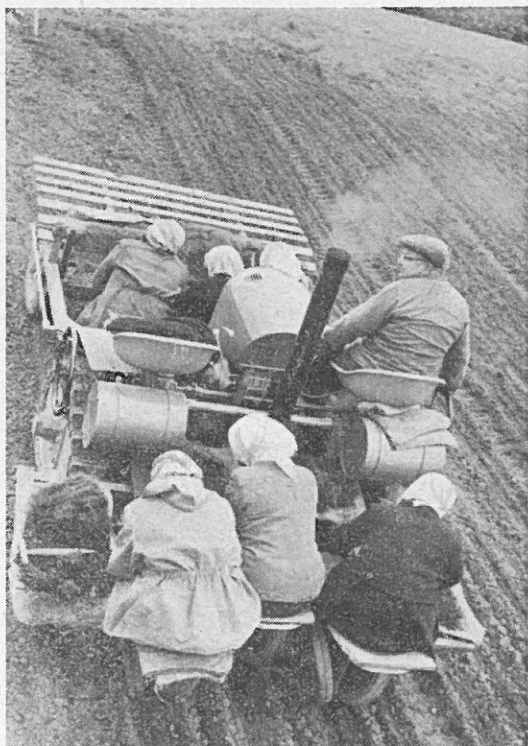
Abb. 1: Geräteträger „KULTIMAX“ mit 6 Pflanzkörpern als Verschulgerät nach Rumetsch. Hinterräder durch Raupen ersetzt. Reihenabstand = 20 cm. Fotohaus Baumbach, Hanau.
