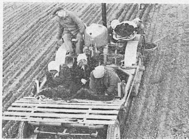
Abb. 2: Geräteträger „KULTIMAX“ im Einsatz als Verschulgerät. Vorderer Teil. Fotohaus Baumbach, Hanau.
