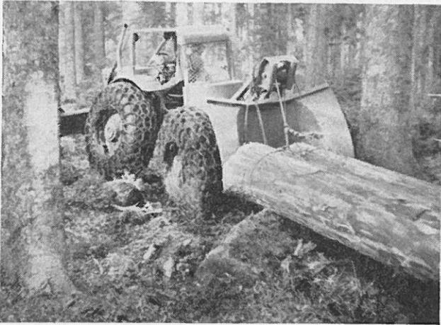
Abb. 7: **Tree-Farmer KL 820**, ca. 55 PS/DIN mit Knicksteuerung und Eintrommelwinde Gearmatic, ca. 100 m Seillänge, mit Seilrollenbock (Rollenhöhe 192 cm), ohne Tragbergstütze — Geschwindigkeit bis 25 km/h. — Noch nicht TÜV-zugelassen. — Auslastungsbasis ca. 10 000 fm jährlich. Gesamtpreis ca. 60 000,— DM. Transportlast hier 6,5 bis 7,0 fm.
