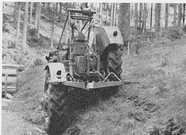
Abb. 8: **Dreirad-Hangschlepper (Prototyp)**. Gebaut durch die Firma Bungartz & Peschke, vorgeführt durch Sägewerksbesitzer Seeber, Helmbach/Pfalz. 40 PS bei 2300 U/min, hydraulische Verstellung der rechten und linken Portalachse, so daß jedes Rad stets mit etwa dem gleichen Gewicht belastet wird. Ausrüstung: Eintrommelwinde mit 80 m Seil, 12,5 mm  $\phi$ , hydraulische Tragbergstütze als Stammzange ausgebildet. Gesamtpreis voraussichtlich ca. 42 000,— DM.
