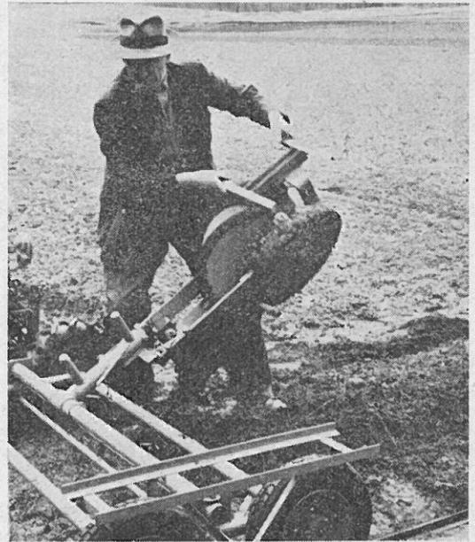
Abb. 4: Wendevorgang durch Schwenken des Pflanzaggregates um die Mittelachse. Der gewünschte Reihenabstand kann durch einfaches Verschieben des Pflanzaggregates auf der Mittelachse gewählt werden.
