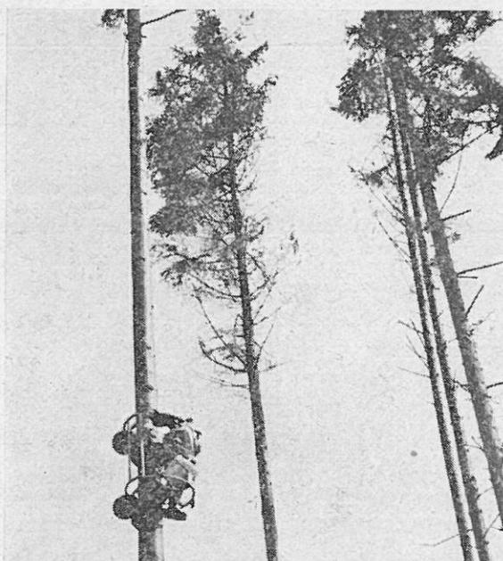
Abb. 6: Rücklauf des Baumentasters nach Aufastung einer Fichte bis zu einer Höhe von 12 m.
