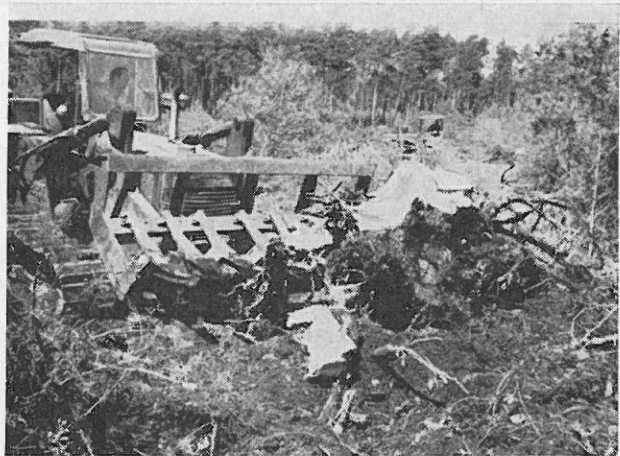
Abb. Roderaupe TD 14 mit Wurzelrechen des Maschinenhofes Misburg (siehe Seite 53, Exkursion Lüß; foto Miller)
