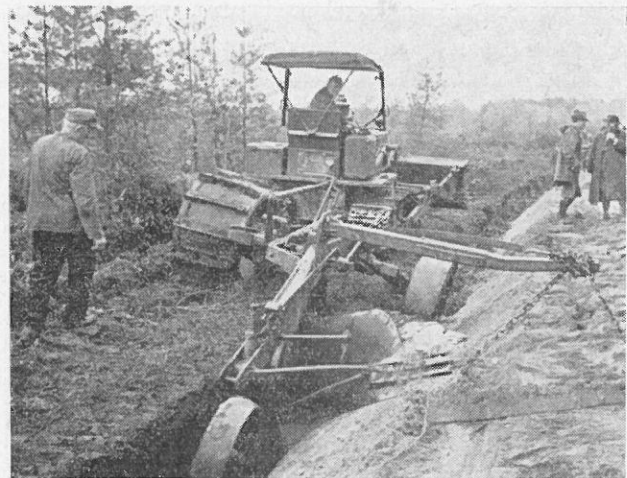
Abb. Hanomag-Raupe K 7 mit Eberhardt-Tiefbeetpflug TBT des Maschinenhofes Misburg; Abb. gehört zu Seite 53 (Exkursion Lüß; foto Jahn)
