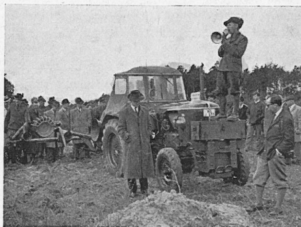
Abb. Exkursion im Forstverband Salzhausen: Oberförster Zacharias erläutert seinen Maschinenpark. Man beachte die Gegengewichte für die angebaute Cambio-Entrindungsmaschine (foto Jahn)
