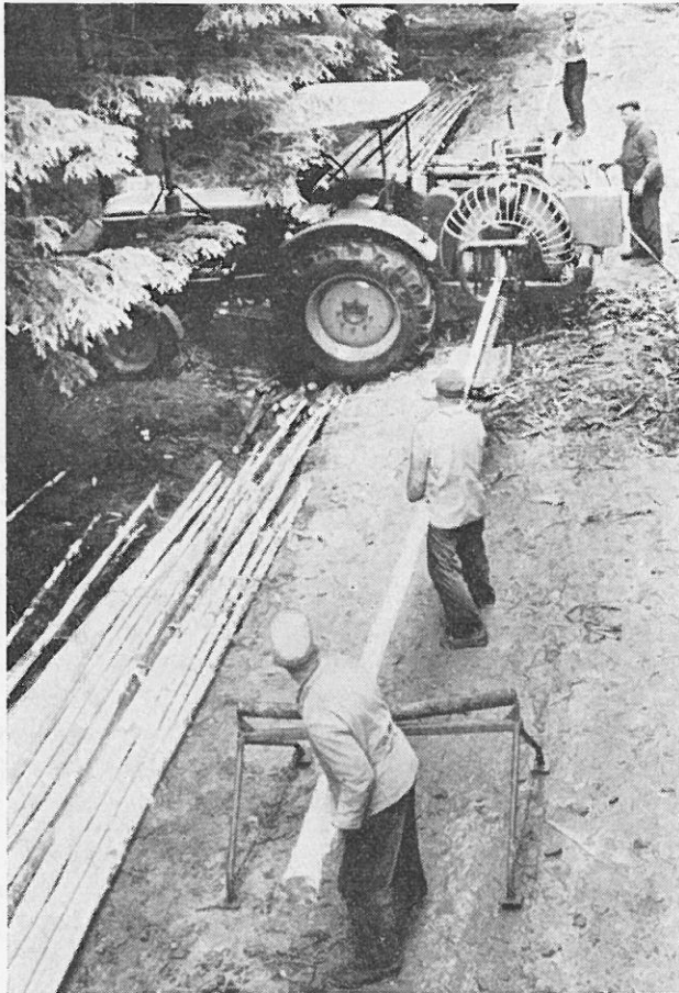
Abb. 3: Entrindungsmaschine Cambio 35; Organisation des Arbeitsplatzes bei Langholzentindung.
