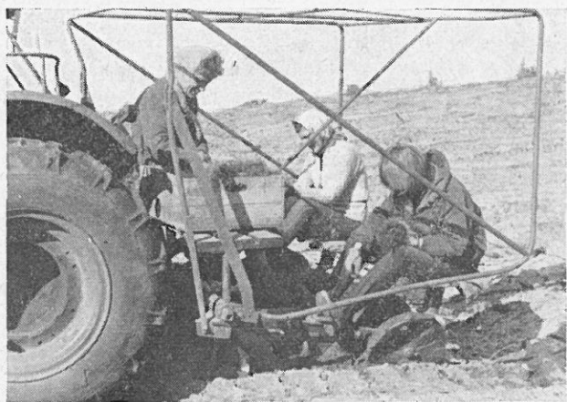
Abb. 5: Pflanzmaschine Accord mit zwei Aggregaten (verstärkt).
