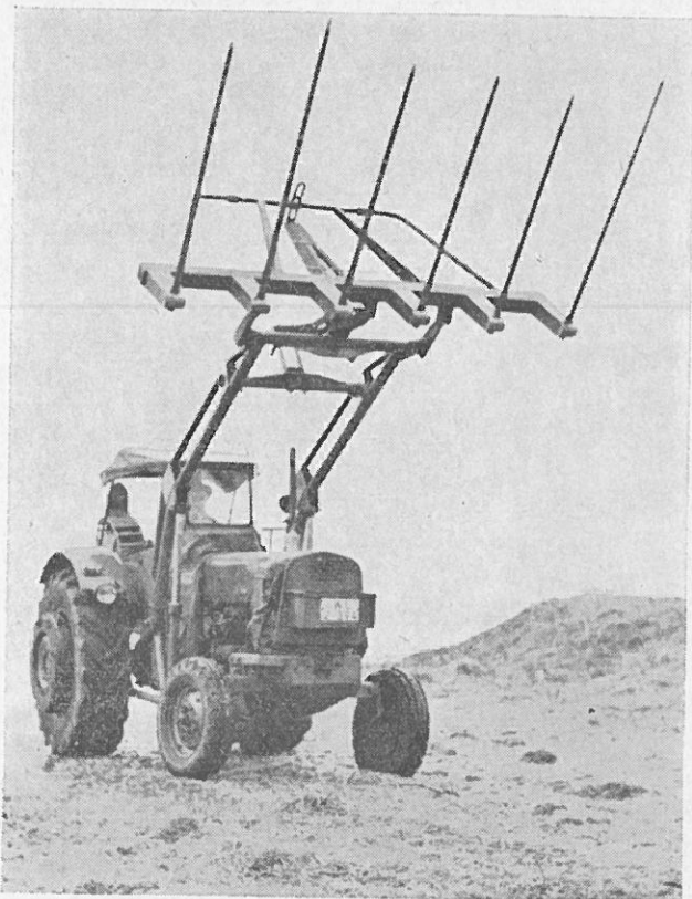
Abb. 4: Buschräumgerät am Frontlader des Ferguson MF 65.
