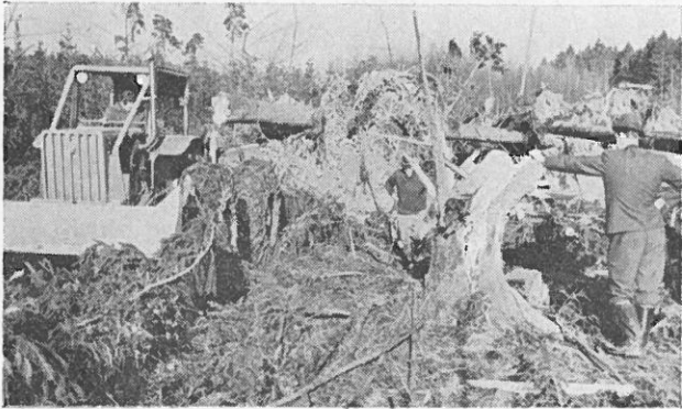
Abb. 3 Bringungsspezi­schlepper (Tree-Farmer) beim Entzerren von Windwurfhölzern
