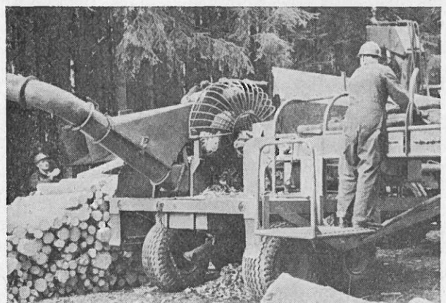
Abb. 1 Cambio-Entrindungsmaschine für Schichtholz, Typ „Korsnäs“ mit Ladekran (3-Mann-Bedienung)
