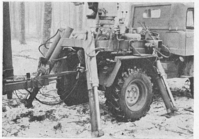
Abb. 5 Abstützvorrichtungen am Unimog 406, 65 PS beim Arbeiten mit Ladekran
