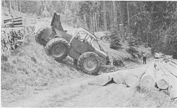
Abb. 2 Bringungsspezi­schlepper (Timberjack Typ 205) beim Poltern
