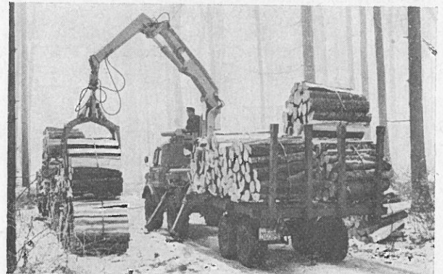
Abb. 4 Entrindungszug aus Unimog 406, 65 PS mit Atlas-Ladekran Typ 3001 und Gigant-Schichtholzanhänger
