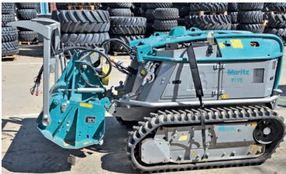
Bild 5 Kompakt-Geräteträger Pflanzel Typ „Moritz FR 70/75“; Konfiguration Geräteträger mit Forstmulcher (Foto Weise)
