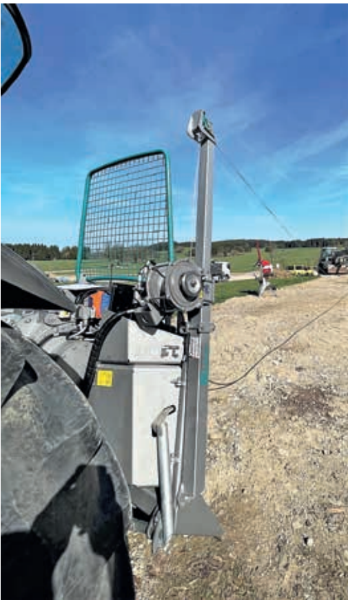
Bild 7 Seilauszugwinde Bauart Pfanzelt für Bodenumlaufzugseilverfahren (Foto Lippert)
