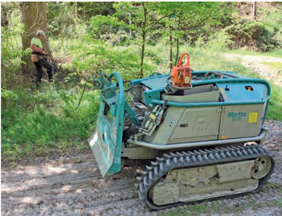
Bild 3 Kompakt-Geräteträger Pfanzelt Typ „Moritz FR 70/75“; Konfiguration Spezialmaschine Windenträger (Foto Weise)
