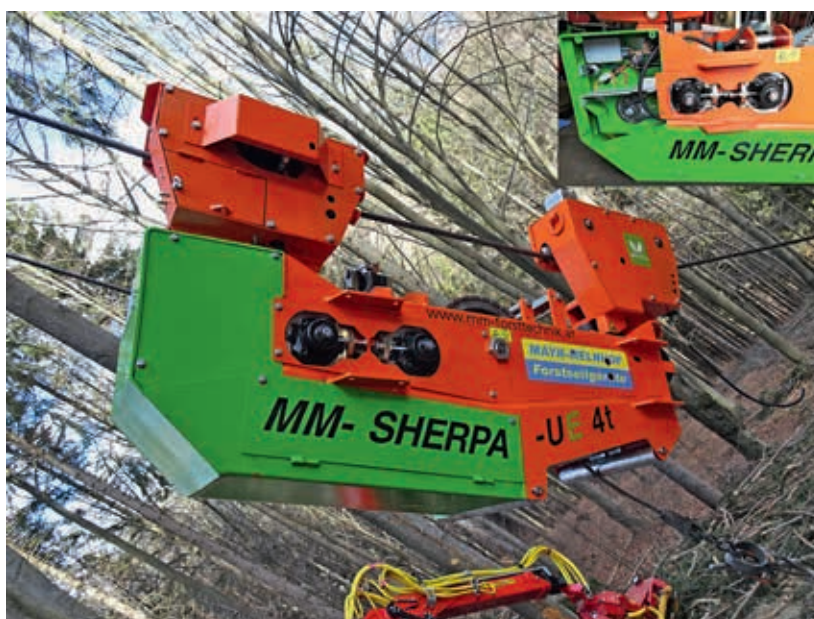
Bild 9 Laufwagen Mayr Melnhof-Sherpa UE 4; Ausführung Mayr Melnhof-Sherpa UE 4L; Motorgenerator zum elektrischen Antrieb der Ausspultvorrichtung im Detailbild erkennbar (Foto Nemestothy)
