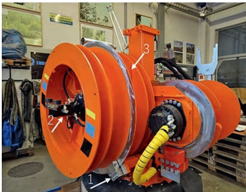
Bild 8 Synchro 45 Boost System als Zusatzausrüstung für das Kombi-Seilgerät MM-Syncrofalke-U-3 t; 1 Bremszange, 2 Hydraulikananschluss (Drehdurchführung) zum Ausgleichs-/Boostmotor, 3 unterstützte Zugseiltrommel (Foto Nemestothy)
