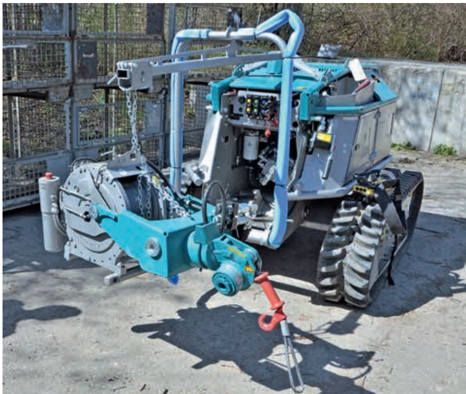
Bild 4 Vorrichtung zum Umbau des Kompakt-Geräteträgers Pfanzelt Typ „Moritz FR 70/75“ vom Windenträger zum Universal-Geräteträger; ausgefahrene Winde; gut erkennbar der Tutum Sicherheitsgriff (Foto Weise)
