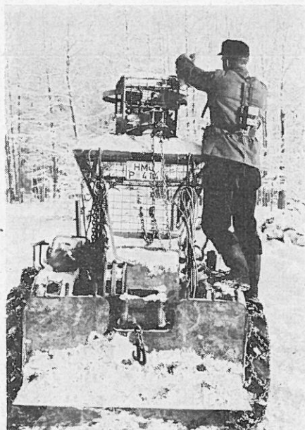
Abb. 2: Die funkferngesteuerte Kleinseilwinde „Radiotir-Anlage“ ist auf dem Überrollbügel montiert, der Sender wird vom Fahrer über einen Schaltknopf betätigt. Der Fahrer füllt Benzin nach.
