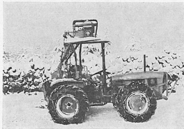
Abb. 1: HOLDER AG 35 mit Allradantrieb, Knicksteuerung, Forstausrüstung und RADIOTIR-Anlage. (Foto: Heil)
