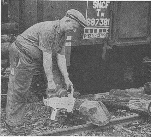
Abb. 3: Probenahme aus Rundholz mit Motorkettensäge.
