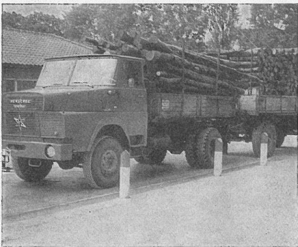
Abb. 4: Ermittlung des Frischgewichts G_u auf Brückenwaage.
