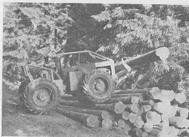
Abb. 17: Timberjack, Stamm mittels Polterschild hydraulisch angehoben, befährt Polter (Aufpoltern)
