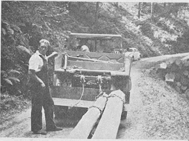
Abb. 10: Unimog 411, 32 PS, mit Welte-Aggregat, Doppeltrommelwinde, Pritsche und Tragbergstütze
