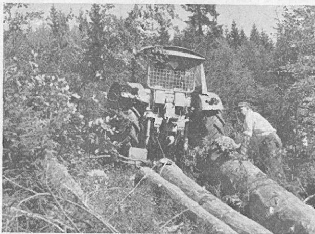
Abb. 4: Bergauftransport mit Forstradschlepper bei 15 bis 20 Prozent Neigung (Bayr. Wald) — Maximale Transportlast dabei nur 40 bis 50 Prozent der unter ebenen Bodenverhältnissen möglichen —
