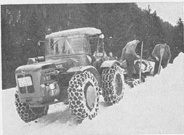
Abb. 7: Allradschlepper 52 PS mit gleichgroßen Rädern bei Winterbringung
