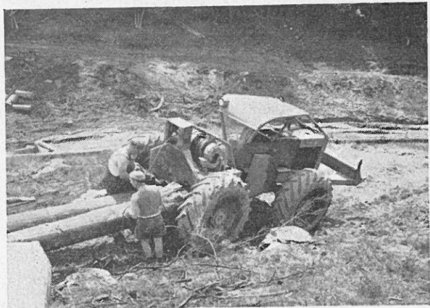
Abb. 8: Bringungsspezialschlepper Timberjack (Knicksteuerung) mit Eintrommelwinde und Frontpolterschild
