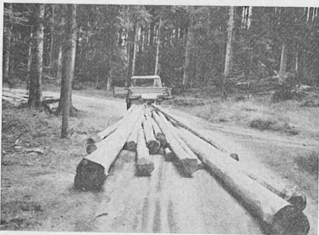
Abb. 11: Unimog 406, 65 PS, mit Werner-Doppeltrommelwinde bei der Bringung von schwächerem Stammholz (20 Stämme mit 7,8 fm) teils aufgesattelt, teils nachschleifend
