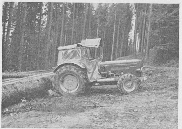
Abb. 6: Universal-Allradschlepper 66 PS mit Bergstütze beim Schubpoltern
