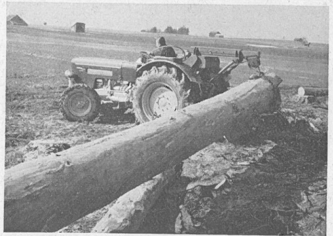
Abb. 16: Schwerer Allradschlepper beim Rücken von am Galgen hängendem Stammholz (pendelnd)
