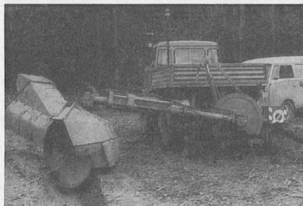
Abb. 1: Grabenreinigungsgerät „Biber“ der Firma Speiser-Maschinenfabrik, angebracht an einem Unimog, angetrieben über Norm-Zapfwelle, Arbeitsgeschwindigkeit etwa 800 m pro Stunde. (fot. Reinecke)
