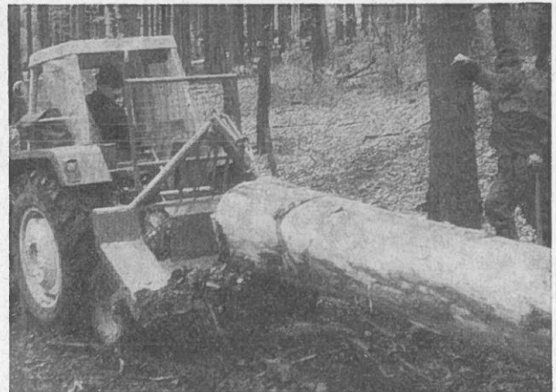
Abb. 3: Steyr-Schlepper 50 A (50 PS) mit Steyr-Rückewagen in der Dreipunkthydraulik beim Anhängen eines Stammes. (fot. Hegar)
