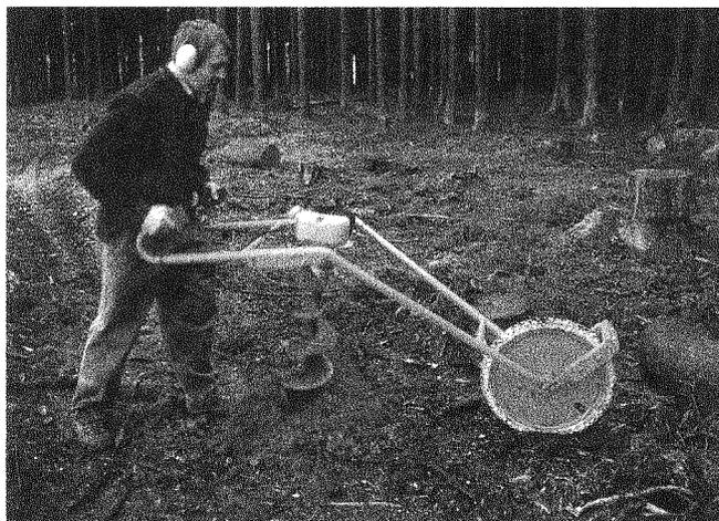
Pflanzfuchs-Erdbohrgerät Typ PF 152
